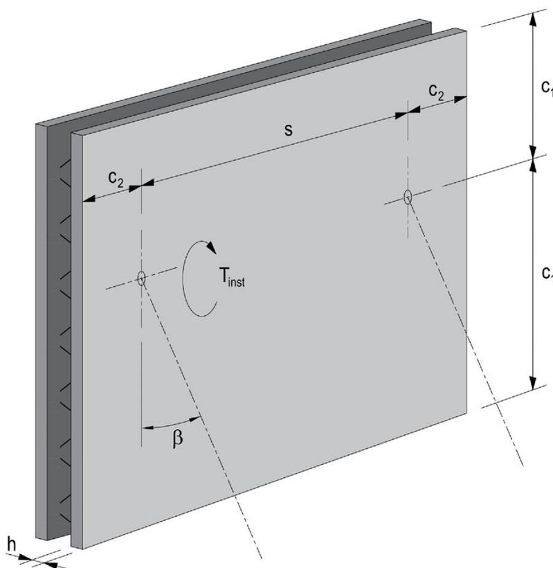
Bild B1: Mindestabstände, Neigungswinkel  $\beta$  der Stütze
