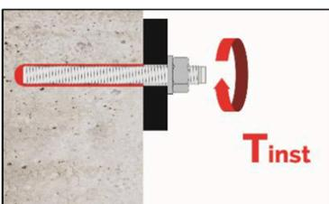
12. Anbauteil mit kalibriertem Drehmomentschlüssel montieren. Maximales Montagedrehmoment (Tabelle B1 oder B3) beachten. Bei statischer Vorgabe (z.B. Erdbeben), Ringspalt im Anbauteil mit Mörtel (Anlage A 2) verfüllen. Dazu Unterlegscheibe durch Verfüllscheibe VFS ersetzen und Mischerreducierung MR verwenden.
