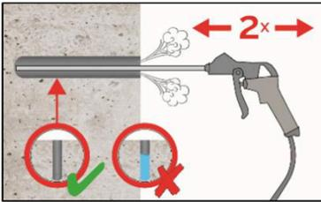
2f. Abschließend Bohrloch mindestens 2x mit Druckluft (min. 6 bar, ölfrei) (Anhang B 4) über die gesamte Verankerungstiefe (ggf. Verlängerung verwenden) ausblasen, bis die ausströmende Luft staubfrei ist.
