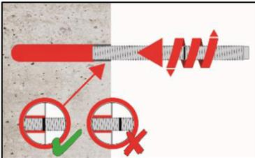
8. Ankerstange mit leichten Drehbewegungen bis zur Markierung einführen.
