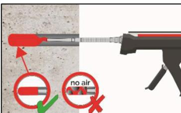
7a. **Injizieren ohne Verfüllstutzen VS:**
