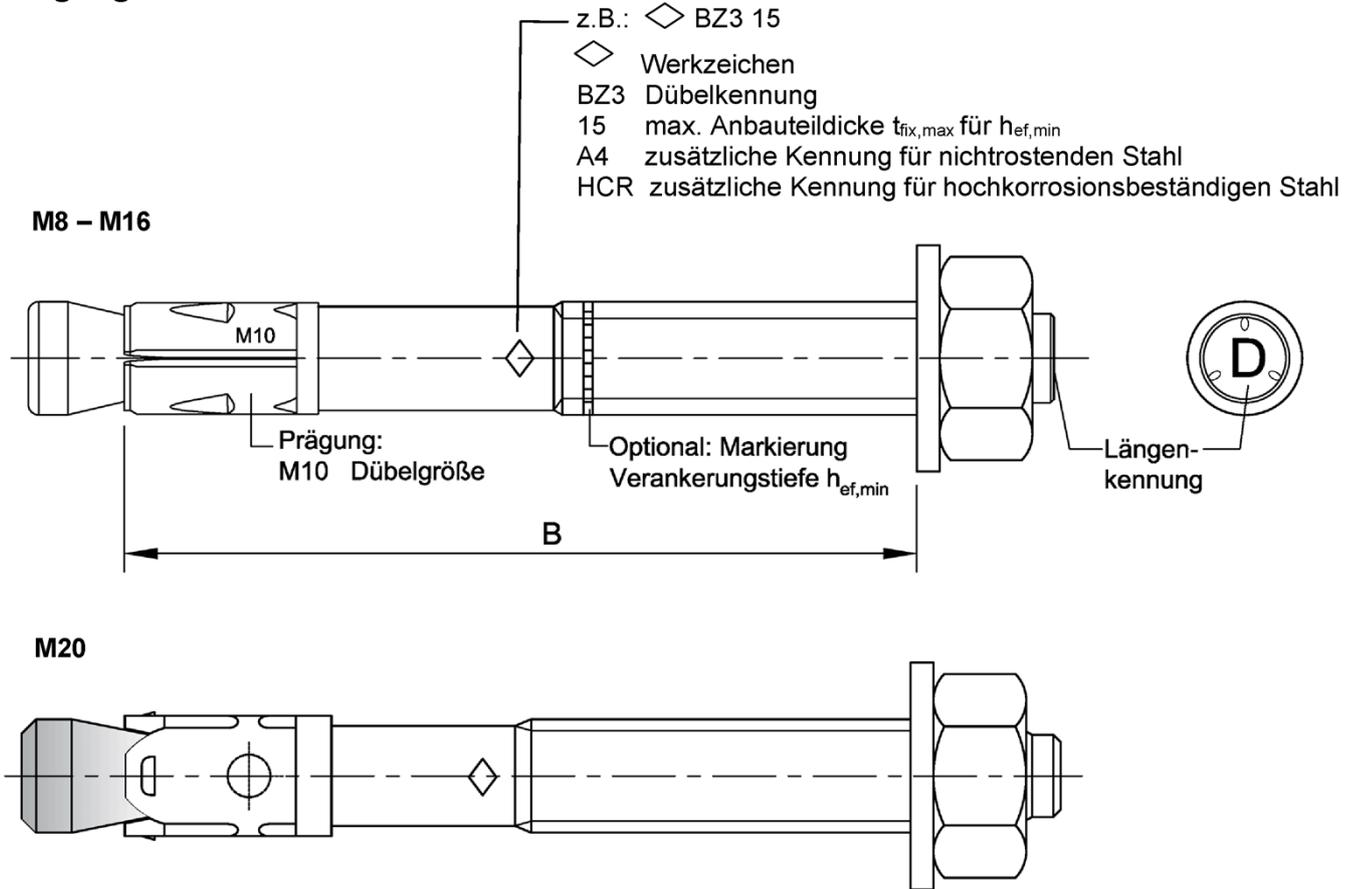
Nutzbare Länge:  $B = h_{ef} + t_{fix}$
