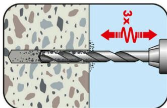
Bei Erreichen der Bohrlochtiefe ( $h_1 = h_{ef} + 31\text{mm}$ ) den Bohrer bei eingeschalteter Bohrmaschine mindestens **3x** vor- und zurückbewegen um das Bohrmehl im Bohrloch zu entfernen (Lüften des Bohrlochs).
