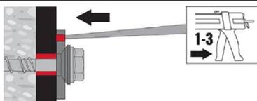
Ringspalt zwischen Stahlelement und Anbauteil mit einem Hilti Injektionsmörtel HIT-HY --- oder HIT-RE ... mit 1 bis 3 Hieben verfüllen. Befolgen Sie die Bedienungsanleitung, die dem entsprechenden Hilti Injektionsmörtel beigelegt ist.
