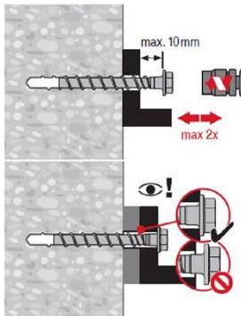
Der Dübel darf maximal zweimal adjustiert werden. Die bei der Adjustierung erfolgte Unterfütterung darf insgesamt maximal 10 mm betragen. Die erforderliche Setztiefe  $h_{nom1}$ ,  $h_{nom2}$  oder  $h_{nom3}$  muss nach der Adjustierung eingehalten werden.
