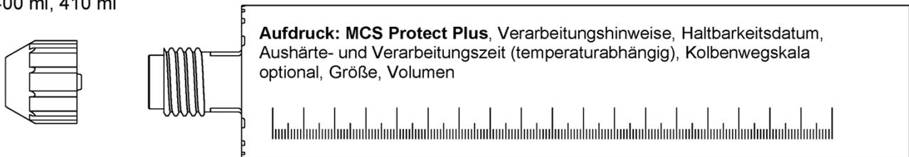
**Mischrohr MCS Protect Plus für Injektionskartuschen bis 410 ml**
