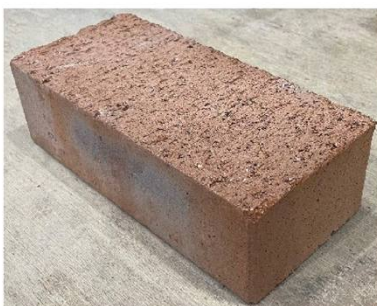
Mauerziegel MZ nach DIN EN 771-1:2015-11
