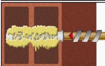
8. Ankerstange mit leichten Drehbewegungen bis zur Markierung einföhren.
