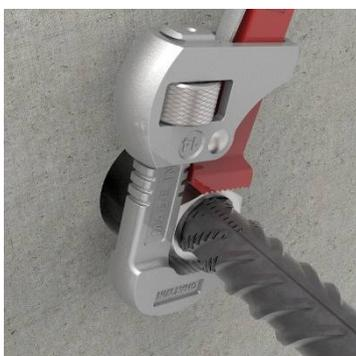
Bringen Sie den Bewehrungsstab in die richtige Position und verwenden Sie einen Standardschlüssel, um die Kontermutter festzuziehen. Für Bewehrungsstäbe mit  $\varnothing \geq 25$  mm ist eine Mindesthebellänge von 0,80 m zu verwenden.
