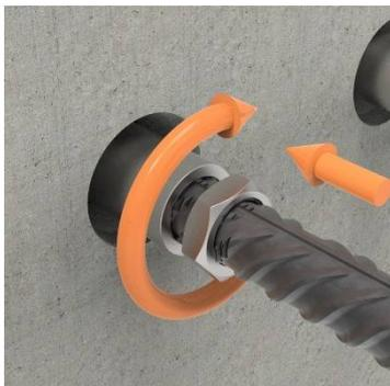
Eindreihen der Muffe von Hand. (Zur Erleichterung der Arbeit kann ein normaler Schraubenschlüssel verwendet werden).
