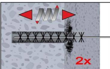
**2e.** Bohrloch mindestens 2x mit Bürste RB gemäß Tabelle B4 drehend über die gesamte Verankerungstiefe (ggf. Bürstenverlängerung RBL verwenden) ausbürsten.
