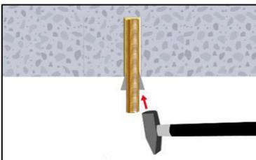
10. Bei Anwendungen in vertikaler Richtung nach oben ist die Ankerstange zu fixieren (z.B. mit Holzkeilen).
