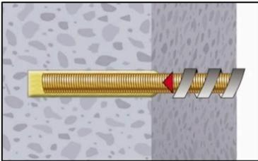
8. Ankerstange mit leichten Drehbewegungen bis zur Markierung einführen.
