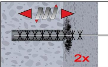
**2b.** Bohrloch mindestens 2x mit Bürste RB gemäß Tabelle B4 drehend über die gesamte Verankerungstiefe (ggf. Bürstenverlängerung RBL verwenden) ausbürsten.
