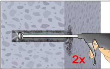
2c. Abschließend Bohrloch mindestens 2x mit Druckluft (min. 6 bar) (Anhang B 4) über die gesamte Verankerungstiefe (ggf. Verlängerung verwenden) ausblasen, bis die ausströmende Luft staubfrei ist.
