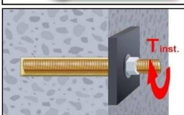
12. Anbauteil mit kalibriertem Drehmomentschlüssel montieren. Maximales Montagedrehmoment (Tabelle B1 oder B3) beachten.
