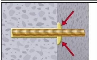
9. Ringspalt zwischen Ankerstange und Beton muss komplett mit Mörtel gefüllt sein (bei Durchsteckmontage auch im Anbauteil). Andernfalls Anwendung vor Erreichen der maximalen Verarbeitungszeit  $t_{work}$  ab Schritt 7 wiederholen.
