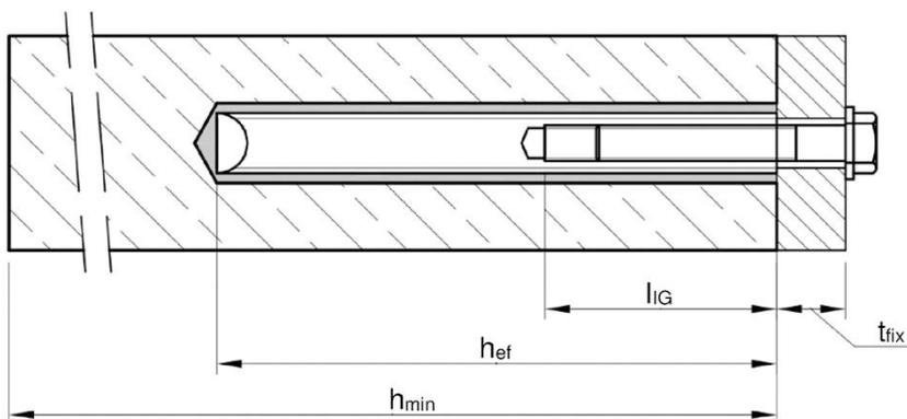
$t_{fix}$  = Dicke des Anbauteils
