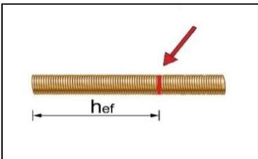
4. Verankerungstiefe auf der Ankerstange markieren. Bei Durchsteckmontage  $t_{fix}$  berücksichtigen.
