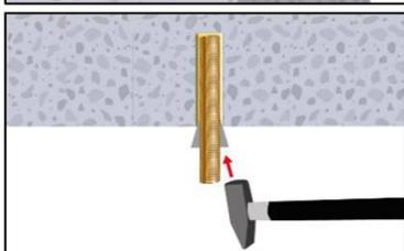
10. Bei Überkopfmontage ist die Ankerstange zu fixieren (z.B. mit Holzkeilen).
