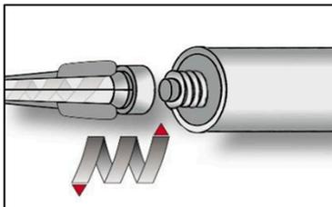
3. Statikmischer CNOZ10-V / CNOZ10-HP aufschrauben und Kartusche in geeignetes Auspressgerät einlegen. Bei Schlauchfolienkartuschen den Schlauchfolienclip vor der Verwendung abschneiden. Bei Arbeitsunterbrechungen, länger als die maximale Verarbeitungszeit  $t_{work}$  (Anhang B 5) und bei neuen Kartuschen, neuen Statikmischer verwenden.
