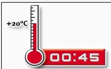
11. Temperaturabhängige Aushärtezeit  $t_{\text{cure}}$  (Anhang B 5) muss eingehalten werden. Die Installation der Anschlussbewehrung und der Schalung, darf nach Erreichen der anfänglichen Aushärtezeit  $t_{\text{cure,ini}}$  fortgesetzt werden. Die volle Belastung darf erst nach Erreichen der vollen Aushärtezeit  $t_{\text{cure}}$  erfolgen.
