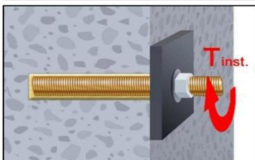
12. Anbauteil mit kalibriertem Drehmomentschlüssel montieren. Maximales Montagedrehmoment (Tabelle B1, B2 oder B3) beachten. Bei statischer Vorgabe (z.B. Erdbeben), Ringspalt im Anbauteil mit Mörtel (Anhang A 3) verfüllen. Dazu Unterlegscheibe durch Verfüllscheibe CFW ersetzen und Mischerreduzierung MR verwenden.
