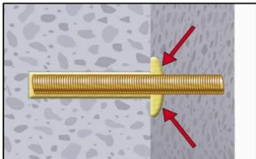
9. Ringspalt zwischen Ankerstange und Verankerungsgrund muss vollständig mit Mörtel gefüllt sein. Bei Durchsteckmontage muss auch der Ringspalt im Anbauteil mit Mörtel verfüllt sein. Andernfalls Anwendung vor Erreichen der maximalen Verarbeitungszeit  $t_{\text{work}}$  ab Schritt 7 wiederholen.
