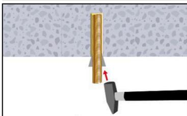
10. Bei Anwendungen in vertikaler Richtung nach oben ist der Ankerstange zu fixieren (z.B. mit Holzkeilen).
