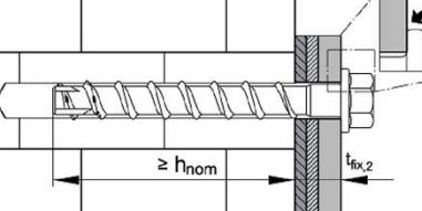
$\geq h_{nom}$ $t_{fix,2}$ | Der Schraubenkopf muss am Anbauteil anliegen und darf nicht beschädigt sein.                               |
