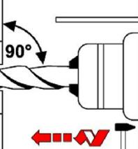
Bohrloch im Hammermodus oder Drehmodus erstellen.
