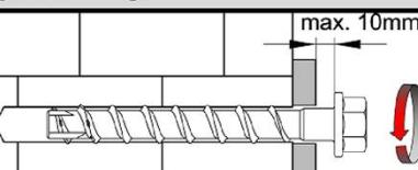
max. 10mm                   | Die Schraube darf maximal 10mm gelöst werden.                                                              |
