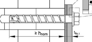
$\geq h_{nom}$ $t_{fix,1}$ | Der Schraubenkopf muss am Anbauteil anliegen und darf nicht beschädigt sein.                               |
