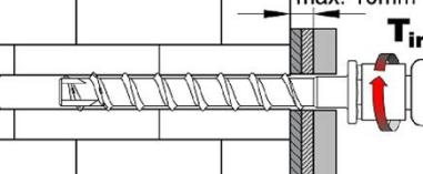
$T_{inst}$                 | Nach Adjustierung die Schraube mit Tangentialschlagschrauber, Akkuschrauber oder Ratsche wieder eindrehen. |
