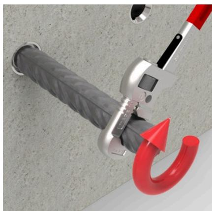
Verwenden eines Standardschlüssels zum Anziehen des Bewehrungsstabes. Für Bewehrungsstäbe mit  $\varnothing \geq 25$  mm ist eine Mindesthebellänge von 0,80 m zu verwenden.
