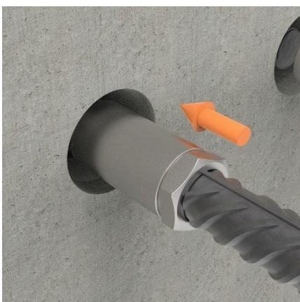
Die Kontermutter ist vollständig auf dem Bewehrungsstab der 2. Phase eingedreht; Muffe und Kontermutter liegen aneinander an.
