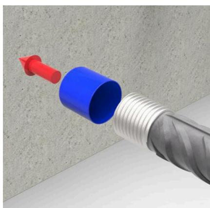
Entfernen der Kappe vom Verbindungsstab.
