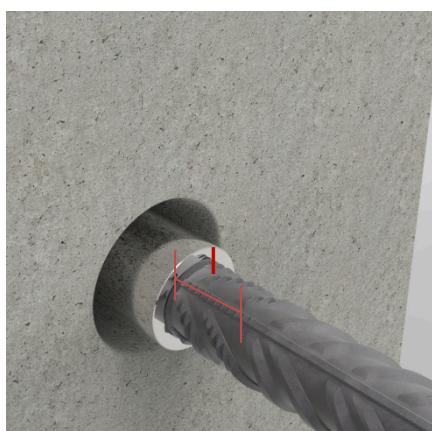
Nach Abschluss der Montage muss die sichtbare Gewindelänge „l“ zwischen den unten angegebenen Grenzwerten liegen.
