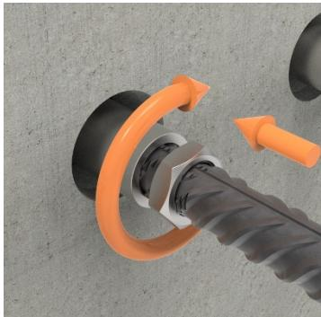
Eindrehen der Muffe von Hand. (Zur Erleichterung der Arbeit kann ein normaler Schraubenschlüssel verwendet werden).
