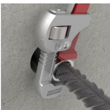
Bringen Sie den Bewehrungsstab in die richtige Position und verwenden Sie einen Standardschlüssel, um die Kontermutter festzuziehen. Für Bewehrungsstäbe mit  $\varnothing \geq 25 \text{ mm}$  ist eine Mindesthebellänge von 0,80 m zu verwenden.
