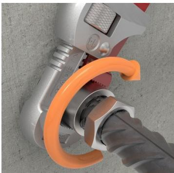
Verwenden eines Standardschlüssels zum Anziehen der Muffe. Für Bewehrungsstäbe mit  $\varnothing \geq 25 \text{ mm}$  ist eine Mindesthebellänge von 0,80 m zu verwenden.
