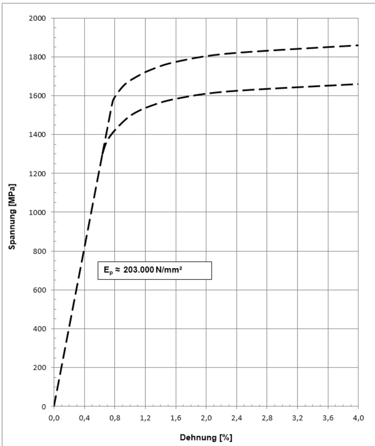
Die Linien geben eine Orientierung für den prinzipiellen Spannungs-Dehnungs-Verlauf bei Annahme des Rechenwerts des E-Moduls ( $E_p$ ) von 203.000 N/mm<sup>2</sup>.
