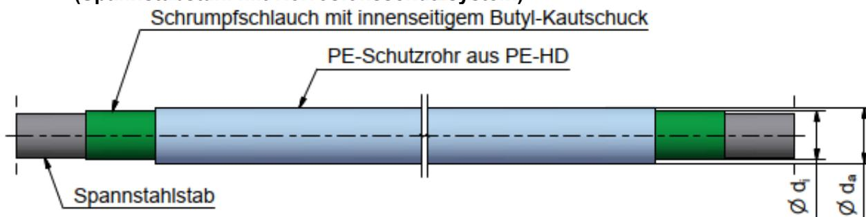
Die Bezeichnung des PE-Schrumpfschlauches besteht aus dem Außendurchmesser im ungeschwumpften Ausgangszustand und dem Wert des kleinstmöglichen Stabdurchmessers auf den der PE-Schrumpfschlauch geschwumpft werden kann, siehe Tabelle 3.
