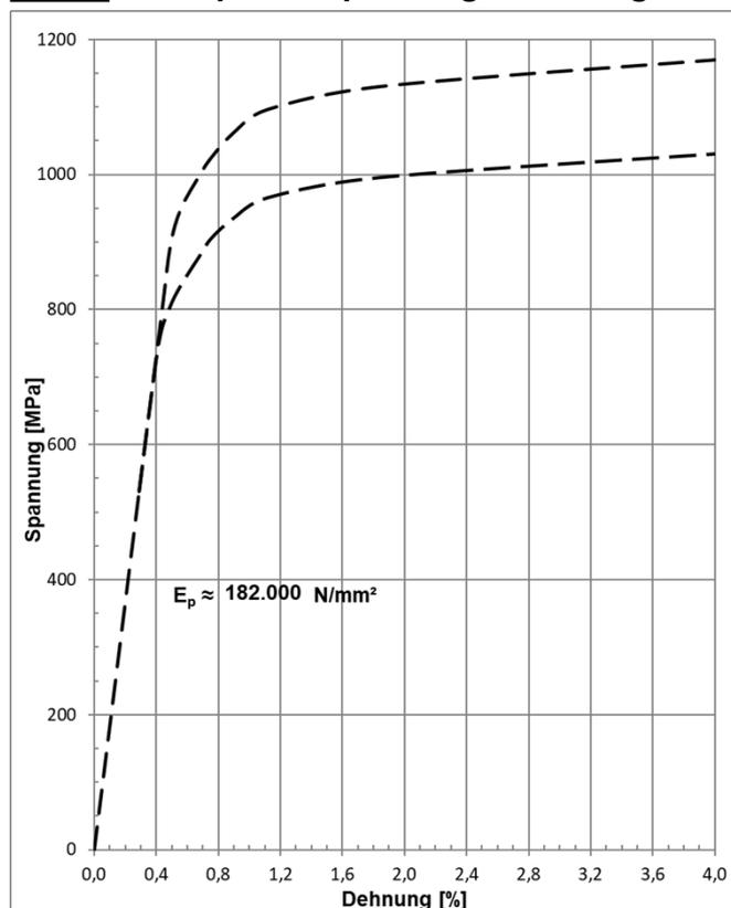
Die Linien geben eine Orientierung für den prinzipiellen Spannungs-Dehnungs-Verlauf bei Annahme des Rechenwerts des E-Moduls ( $E_p$ ) von  $182.000 \text{ N/mm}^2$
