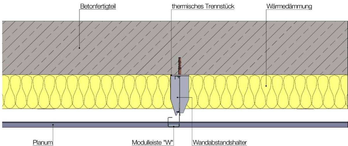
Fassadensystem Planum mit Fassadenelementen aus Stahl und seine Produkte
