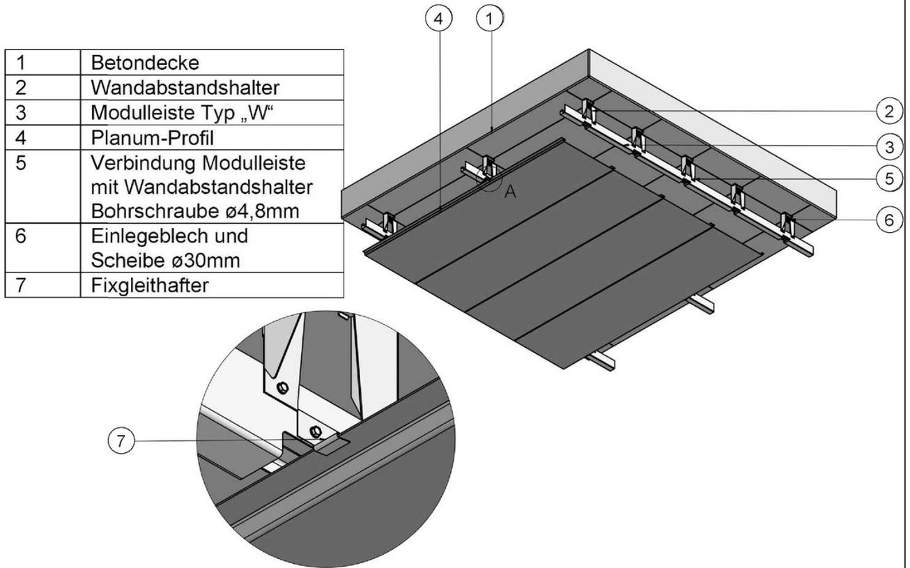
Bild 3: Beispiel für Befestigung als Unterdecke auf Fertigbetonteile
