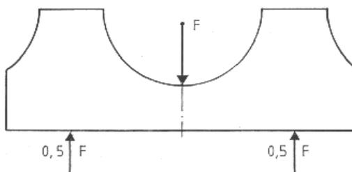
**Bild 1:** Belastungsanordnung Biegeversuch
