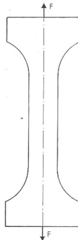
**Bild 2:** Belastungsanordnung Zugversuch
