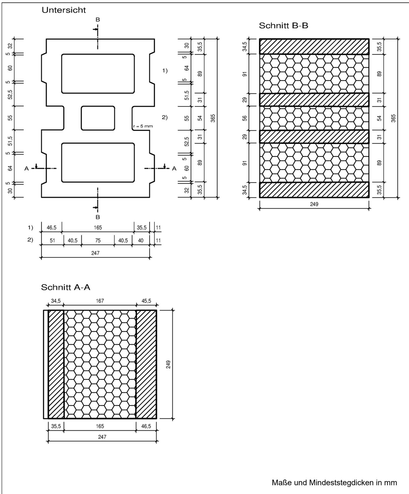
Mauerwerk aus Plan-Hohlblöcken aus Leichtbeton mit integrierter Dämmung aus Steinwollestecklingen - bezeichnet als KLB-Kalopor Plus-Planblöcke -
