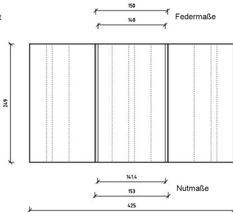
vierseitig geschlossener Mauerstein mit Kammern - ohne Abdeckung oberhalb der Kammern
