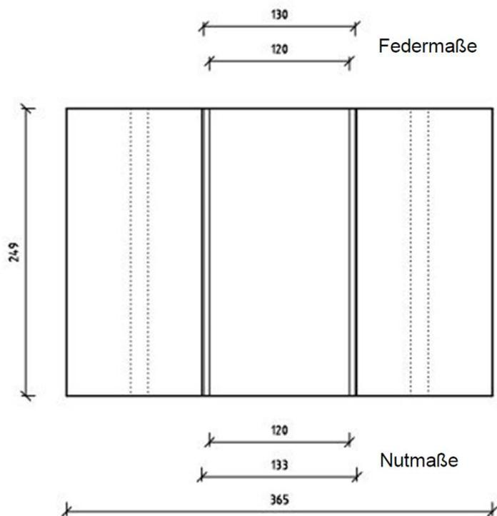
vierseitig geschlossener Mauerstein mit Kammern - ohne Abdeckung oberhalb der Kammern
