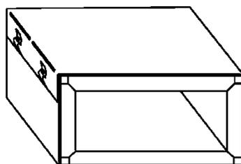
Zubehörteile für feuerwiderstandsfähige Abschottung "Würth Kabelbox kurz"
