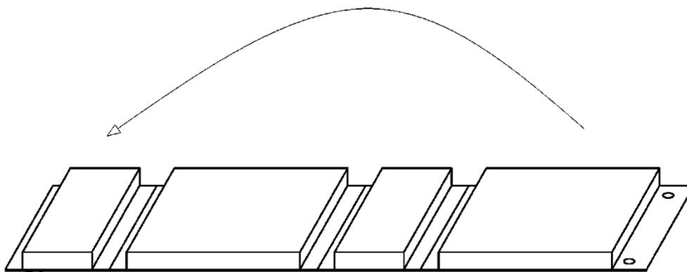
Die vorgekennzeichneten Kanten des Elementes nacheinander um 90° Winkel herumbiegen und zum Schluss die überstehende Lasche in die Schnappverschlüsse einhaken.
