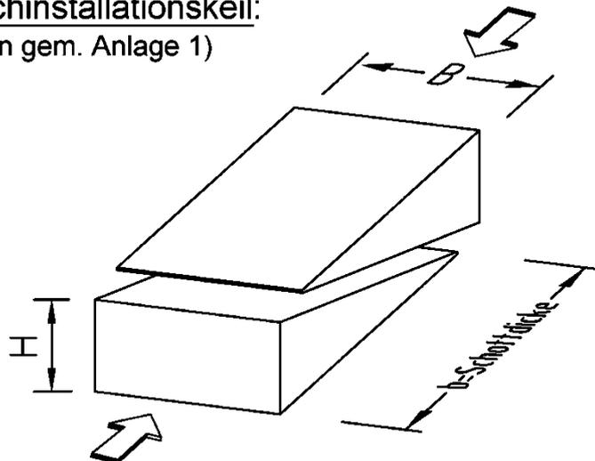
Der Nachinstallationskeil vereinfacht in schwierigen Einbaulagen das nachträgliche Öffnen der Abschottung. Die mit den Nachinstallationskeilen belegte Schottfläche darf eine Größe 30 cm x 15 cm (B x H) nicht überschreiten.
