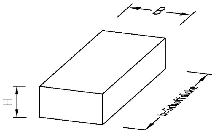
Die Brandschutzblöcke dürfen wahlweise vakuumiert (komprimiert) oder als Nachinstallationskeile in den gleichen Abmessungen hergestellt werden (siehe Anlage 2).
