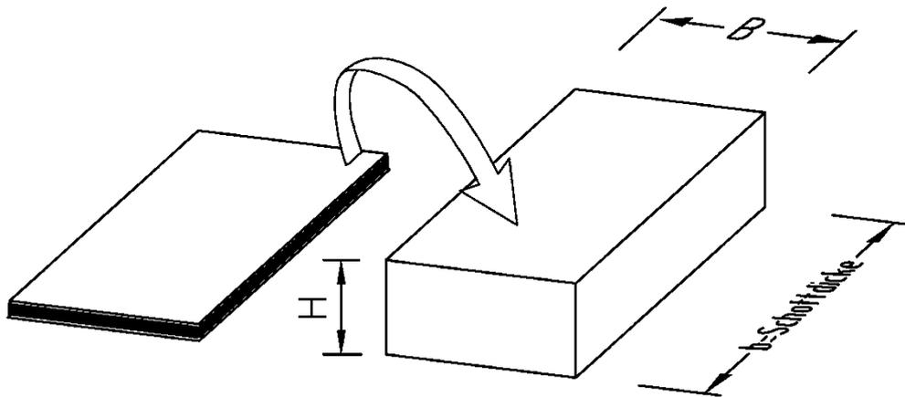
Der vakuumierte Brandschutzblock wird in Restspalte eingefügt und verschließt diese nach Öffnen der Folie. Wahlweise darf der vakuumierte Brandschutzblock mit oder ohne Folie eingebaut werden.
