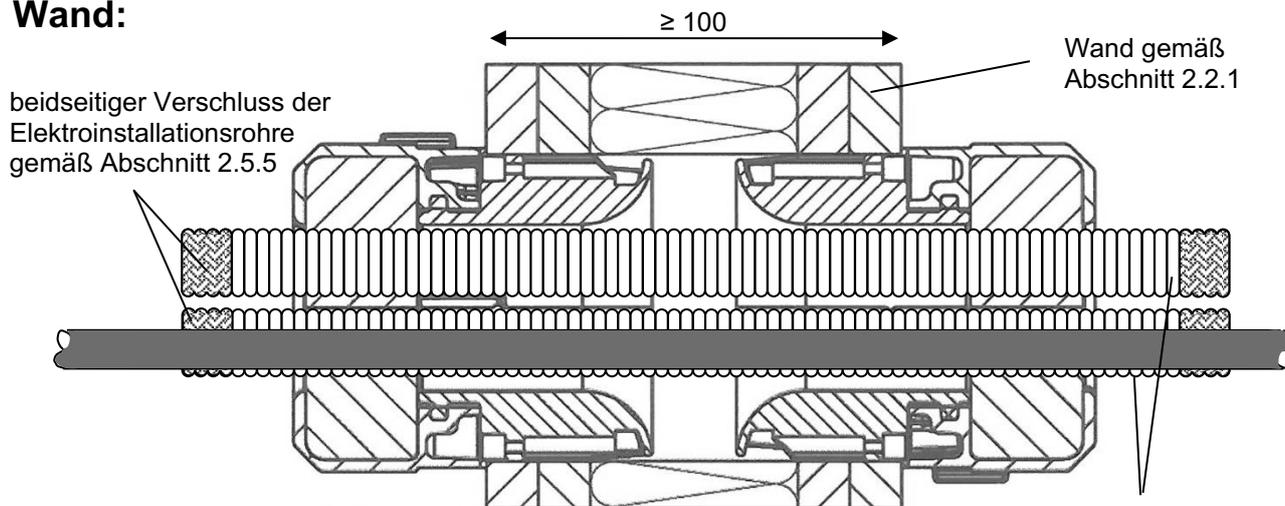
**Stopfen für Elektro-Installationsrohre**
