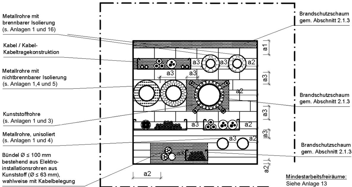
Teilbereiche zwischen Installationen sowie zwischen Installationen und den Öffnungslaibungen können bis zu einer Größe von maximal 450 mm x 500 mm (Breite x Höhe) oder 0,225 m<sup>2</sup> mit Brandschutzschaum gem. Abschnitt 2.1.3 ausgefüllt werden. Spalte zwischen Brandschutzsteinen gem. Abschnitt 2.1.1 und Öffnungslaibung können bis zu einer Breite von 60 mm verschlossen werden.
