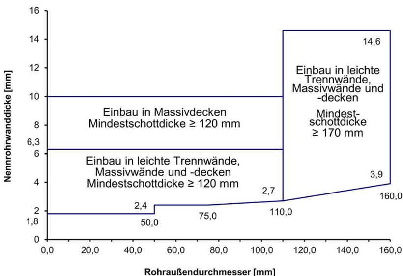
In Wand- und Deckenabschottungen ist bei Rohren der Rohrgruppen A und B nach Anlage 1 "ZZ-Manschette Typ A/AS" entsprechend Anlage 15 vorzusehen.
