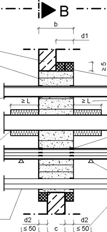
Aufleistung aus nichtbrennbaren Bauplatten gem. Abschnitt 2.1.8 Breite  $\geq 5$  cm
