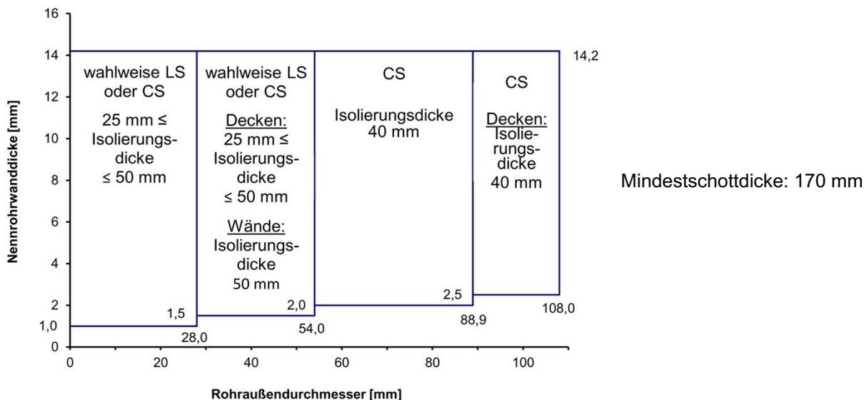
\* Foamglas, Deutsche Foamglas GmbH, Verklebung der Rohrschalen mit Kleber PC 18 und Sicherung durch zwei Spannbänder je Seite in 10 cm bzw. 40 cm Abstand zur Schottoberfläche
