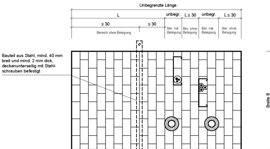
Bei Einbau von Abschottungen mit einer Dicke < 17 cm in Wänden und Decken sind die Schottbereiche ohne Installationen mit einer Länge  $L > 30$  cm mit einer der folgenden Maßnahmen in den betroffenen Bereichen zu sichern (s. Abschnitt 2.5.8.1):
