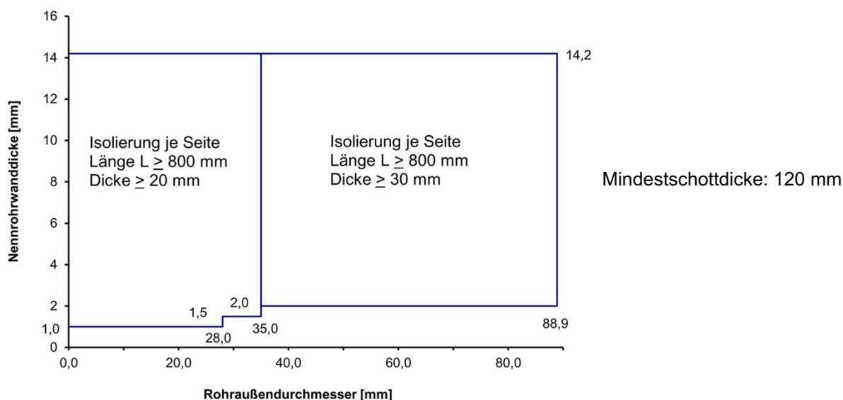
Feuerwiderstandsfähige Abschottung für elektrische Leitungen und/oder Rohrleitungen aus Metall oder Kunststoff "ZZ M21-S90" Kombiabschottung
