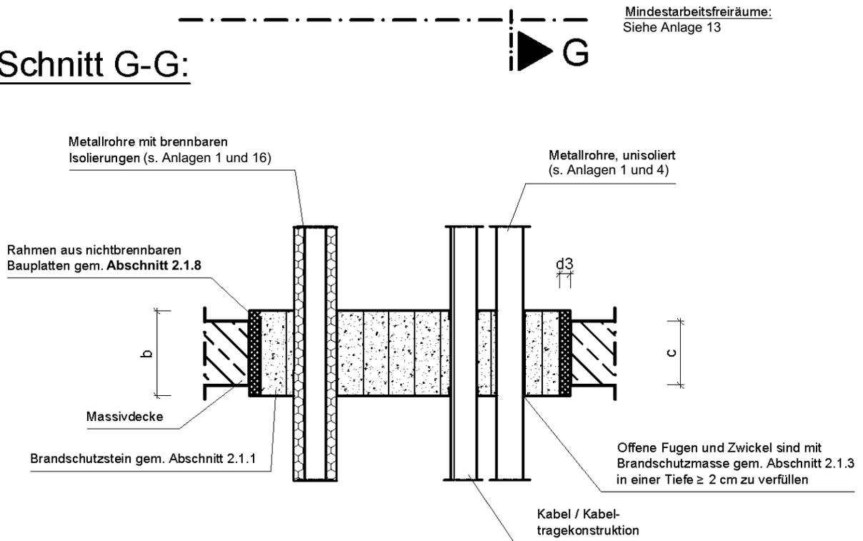
Bei Abschottung von Installationen und einer notwendigen min. Schottdicke von 120 mm **Anlage 20** wird kein Rahmen erforderlich.
