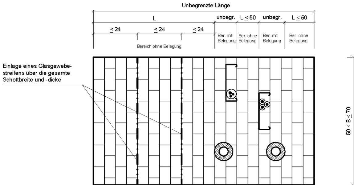
**b) Montage von Stahlbauteilen gem. 2.5.8.2 in Decken:**
