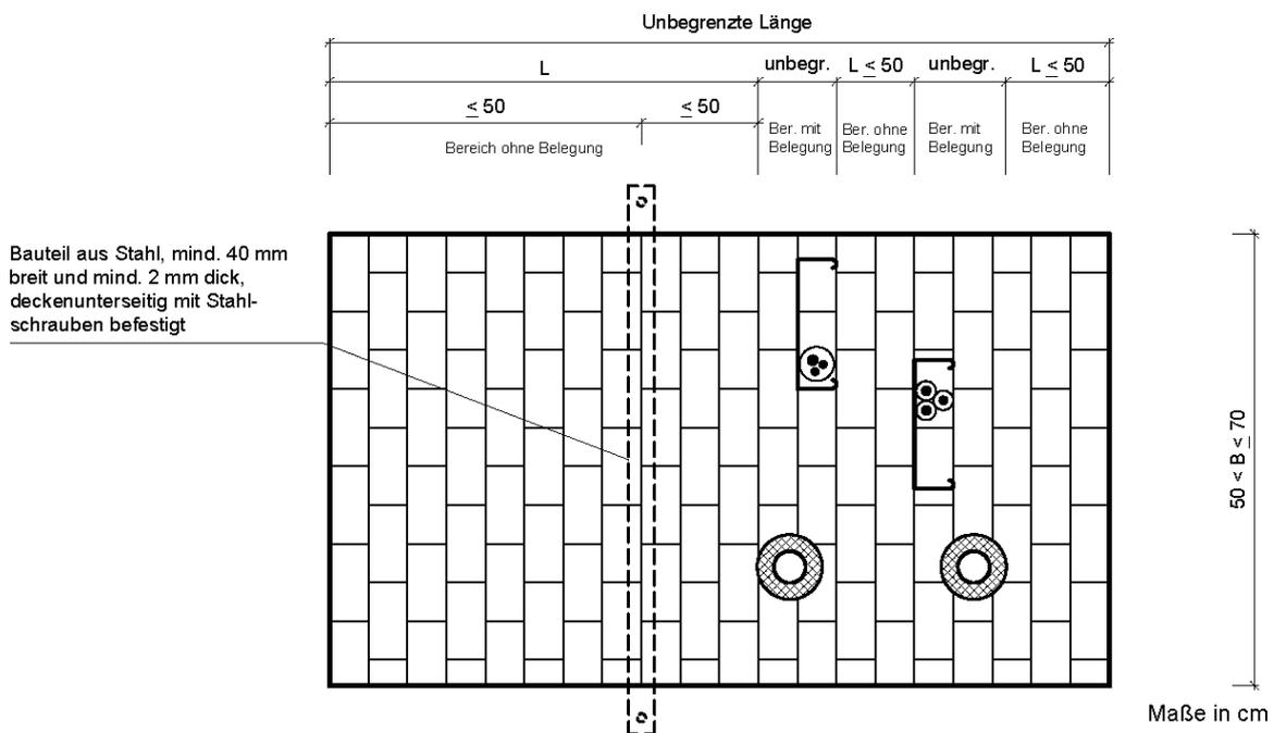
Bei Einbau von Abschottungen mit einer Dicke  $\geq 17$  cm in Decken mit einer Breite von  $50 \text{ cm} < B \leq 70 \text{ cm}$ , sind die Schottbereiche ohne Installationen mit einer Länge  $L > 50$  cm mit einer der folgenden Maßnahmen in den betroffenen Bereichen zu sichern (s. Abschnitt 2.5.8.2):
