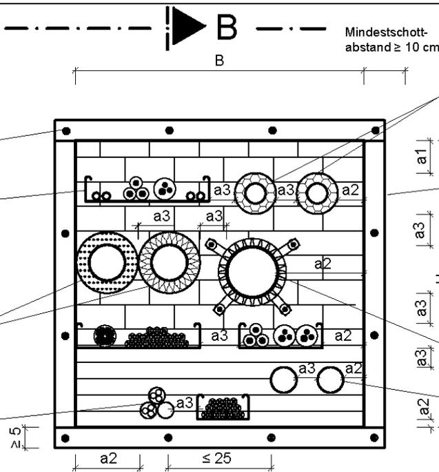
Metallrohre mit brennbarer Isolierung (s. Anlagen 1 und 16)
