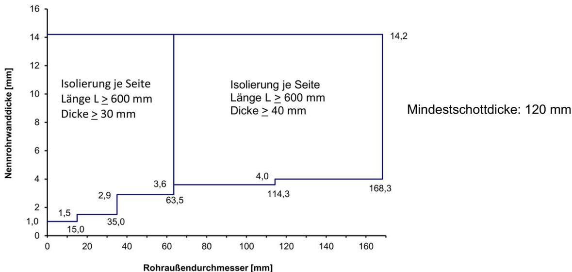
Bei einer Mindestschottdicke von 170 mm dürfen wahlweise Rohre bis zu einem Außendurchmesser  $\varnothing$  35,0 mm und einer Wandstärke  $\geq$  2,6 mm ohne Isolierung durch die Abschottung geführt werden
