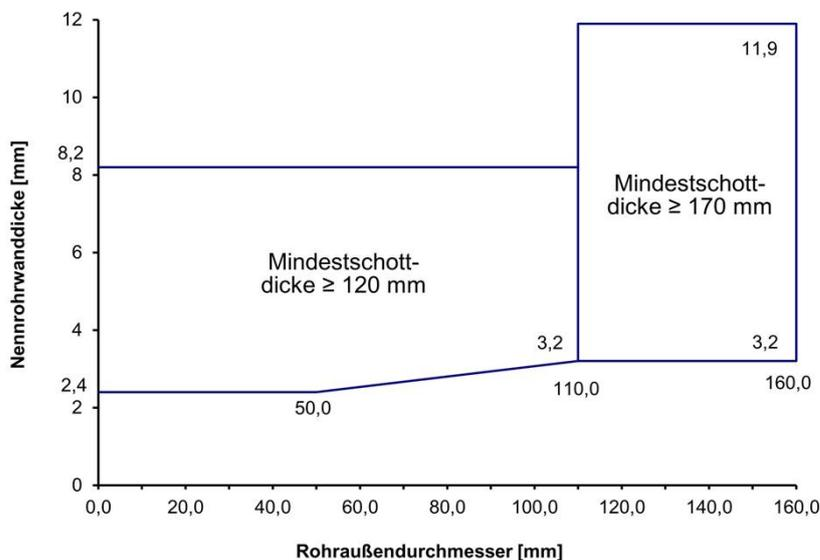
Rohre der Rohrgruppe B nach Anlage 1: PE-HD, PE-LD, PP, ABS, ASA, PE-X, PB, PS
