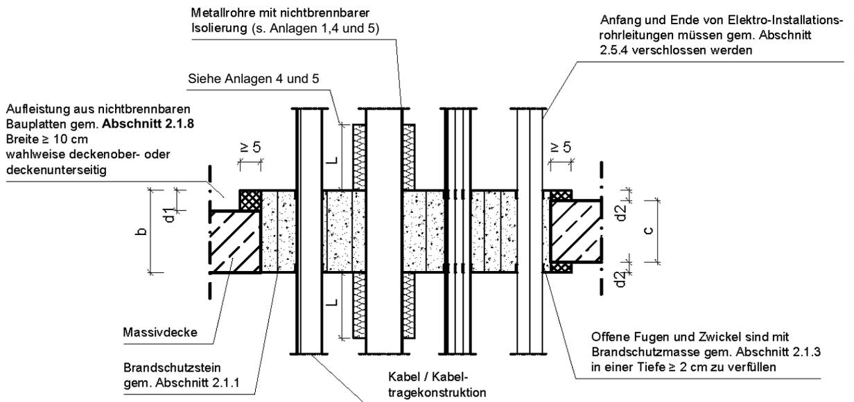
Bei Abschottungen von Installationen und einer notwendigen min. Schottdicke von 120 mm **Anlage 20** wird keine Aufleistung erforderlich.
