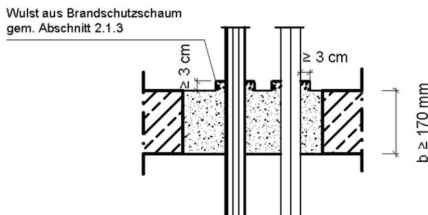
Feuerwiderstandsfähige Abschottung für elektrische Leitungen und/oder Rohrleitungen aus Metall oder Kunststoff "ZZ M21-S90" Kombiabschottung
