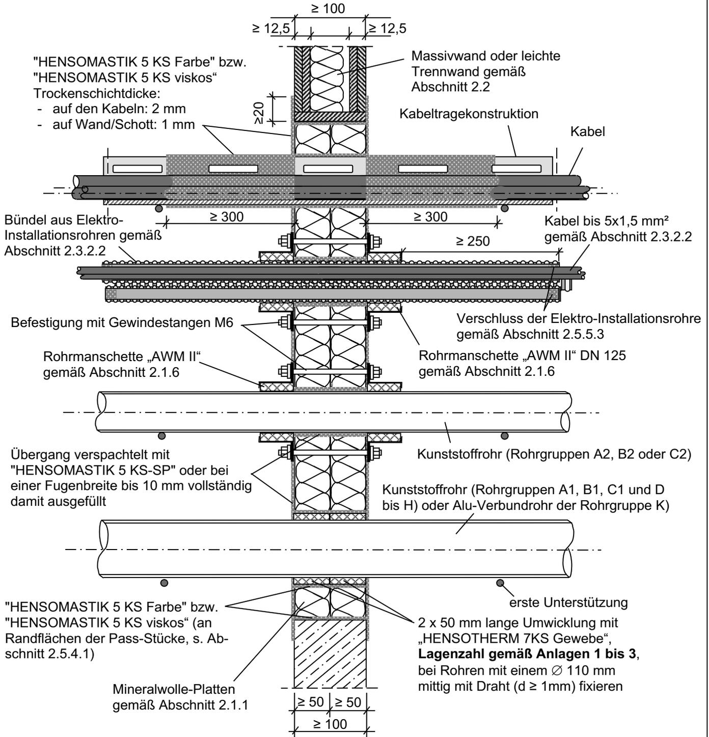
Feuerwiderstandsfähige Abschottung für elektrische Leitungen und Rohrleitungen aus Metall oder Kunststoff "HENSOMASTIK EI 90 2x50 mm"
