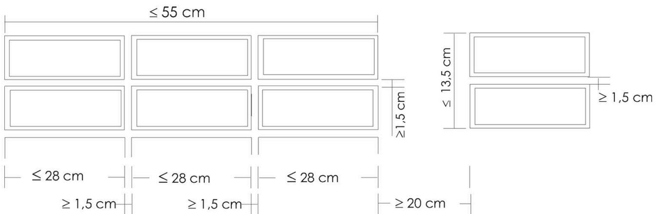
Feuerwiderstandsfähige Abschottung für elektrische Leitungen "Würth Kabelbox kurz"
