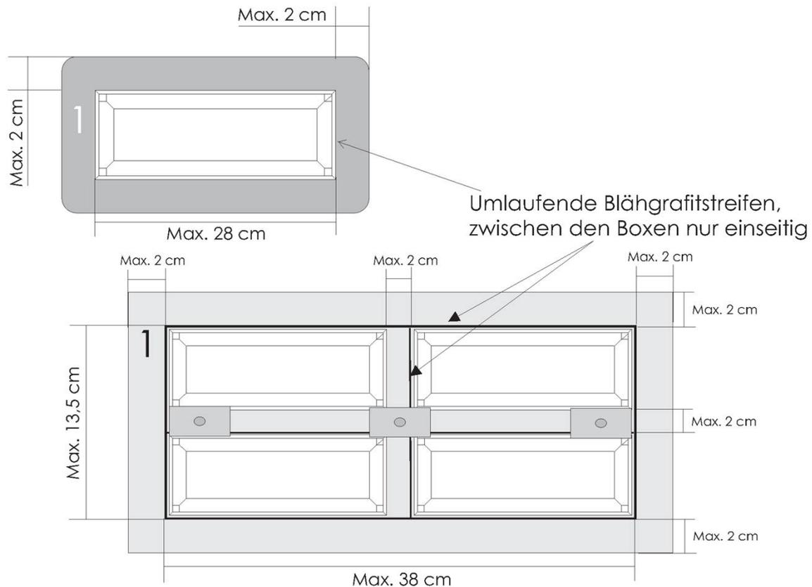
Feuerwiderstandsfähige Abschottung für elektrische Leitungen "Würth Kabelbox kurz"
