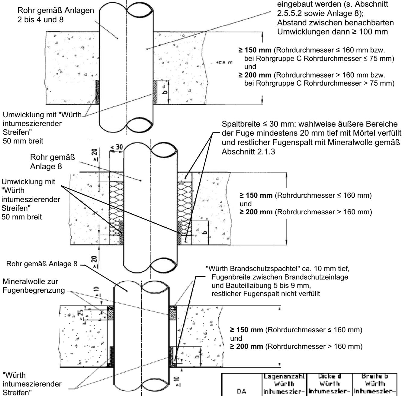
\* Bei Verwendung von PE-Weichschaumstreifen gemäß Abschnitt 2.5.5.2 sowie bei Rohren der Rohrgruppen C bis I sind **5 Lagen** anzuordnen. Bei Rohren der Rohrgruppe C sind bei einem Durchmesser von 75 mm **3 Lagen** ausreichend.
