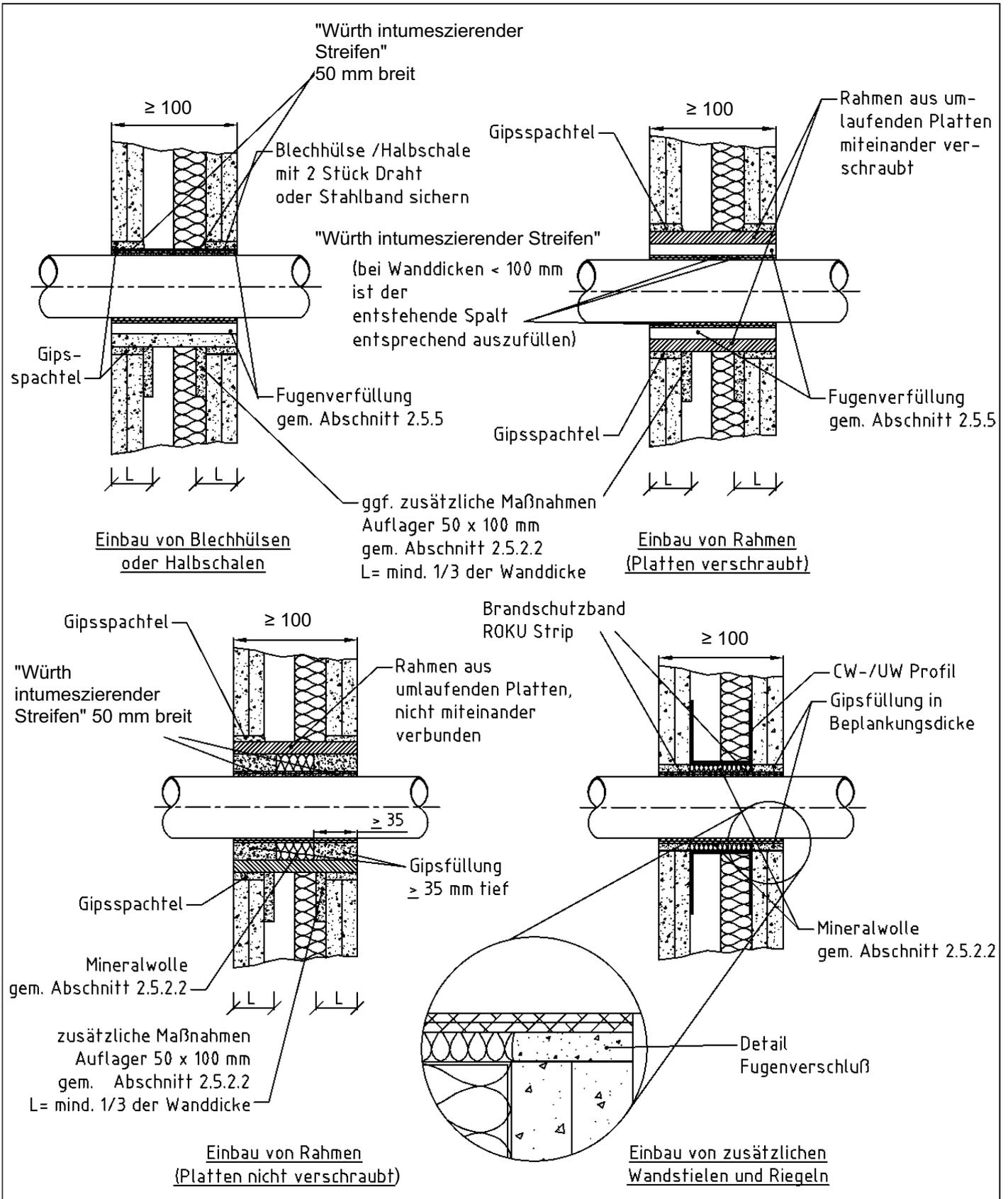
Feuerwiderstandsfähige Abschottung für Rohrleitungen aus Kunststoff "System Würth Rohrabschottung I plus"
