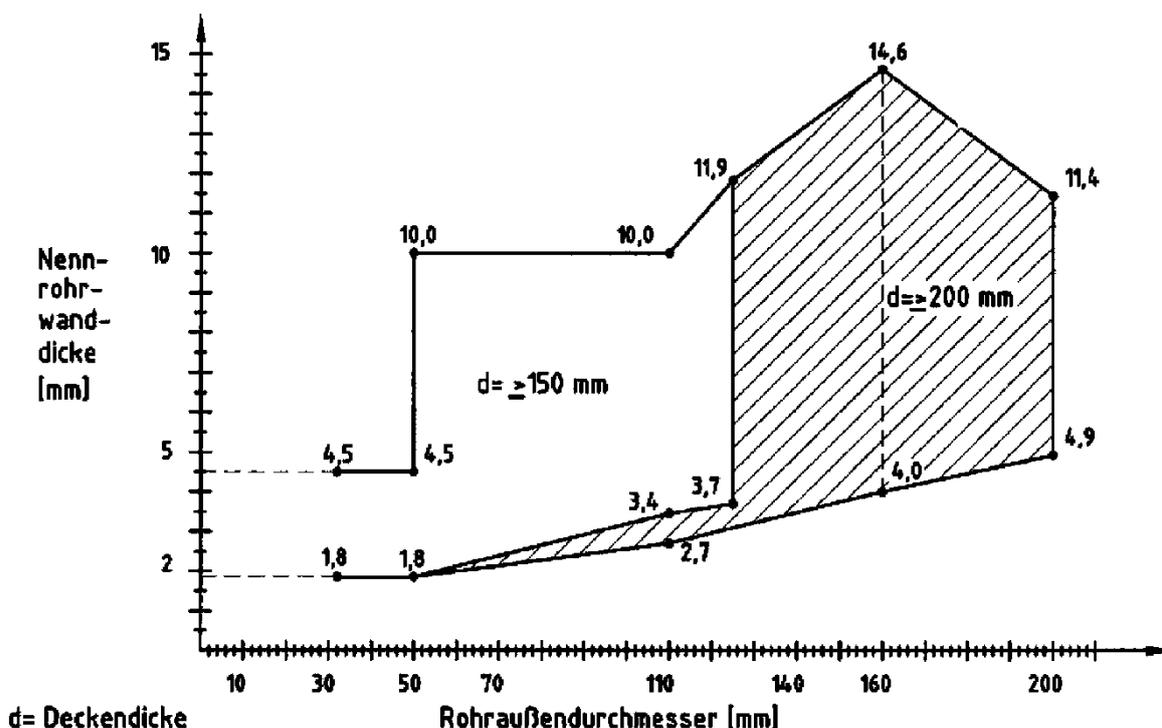
Feuerwiderstandsfähige Abschottung für Rohrleitungen aus Kunststoff "System Würth
