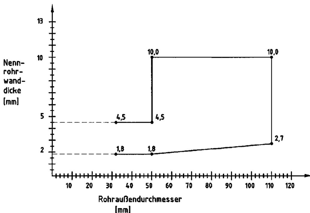
Feuerwiderstandsfähige Abschottung für Rohrleitungen aus Kunststoff "System Würth
