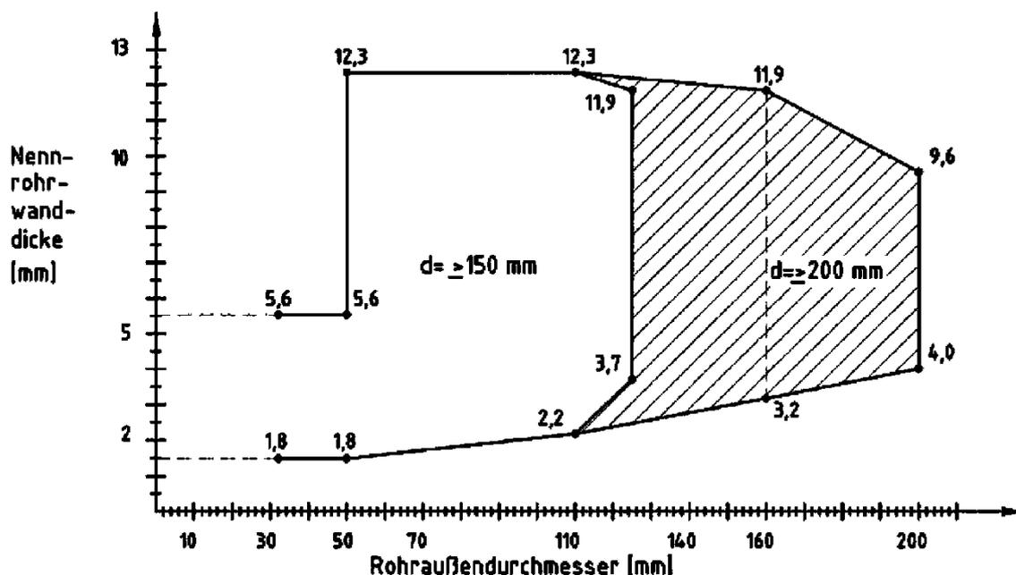
**Rohre gemäß der Rohrgruppe B-3 (Rohre aus PE-HD, LDPE, PP, ABS, ASA, PE-X, PB, ...)
