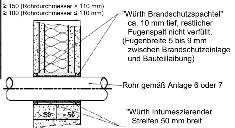
Laibungsbildung bei Errichtung in leichten Trennwänden mit einer Dicke  $> 100$  mm oder mit Aufbau nach Abschnitt 2.2.3 siehe Anlage 11
