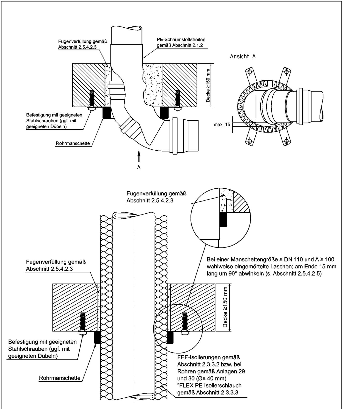
Feuerwiderstandsfähige Abschottung für Rohrleitungen aus Kunststoff "Curaflam System ECO Pro", "System FS-M R2", "System FSC", "System FS-Pro" bzw. "System FStop"
