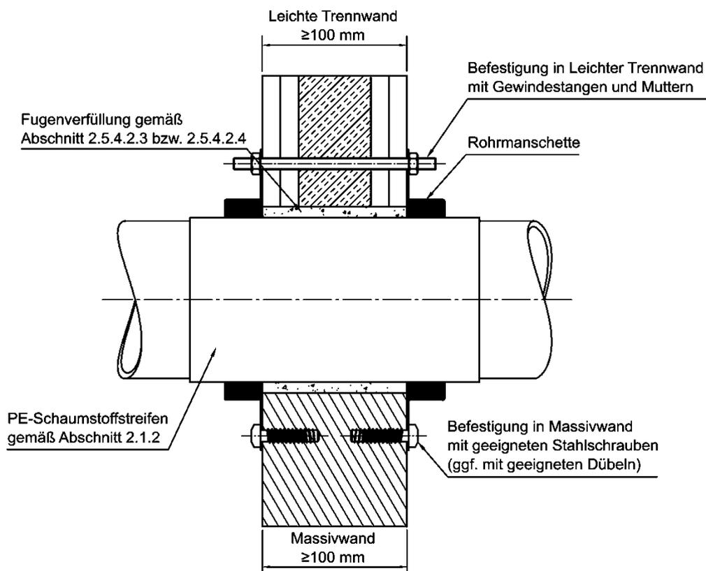
Feuerwiderstandsfähige Abschottung für Rohrleitungen aus Kunststoff "Curaflam System ECO Pro", "System FS-M R2", "System FSC", "System FS-Pro" bzw. "System FStop"
