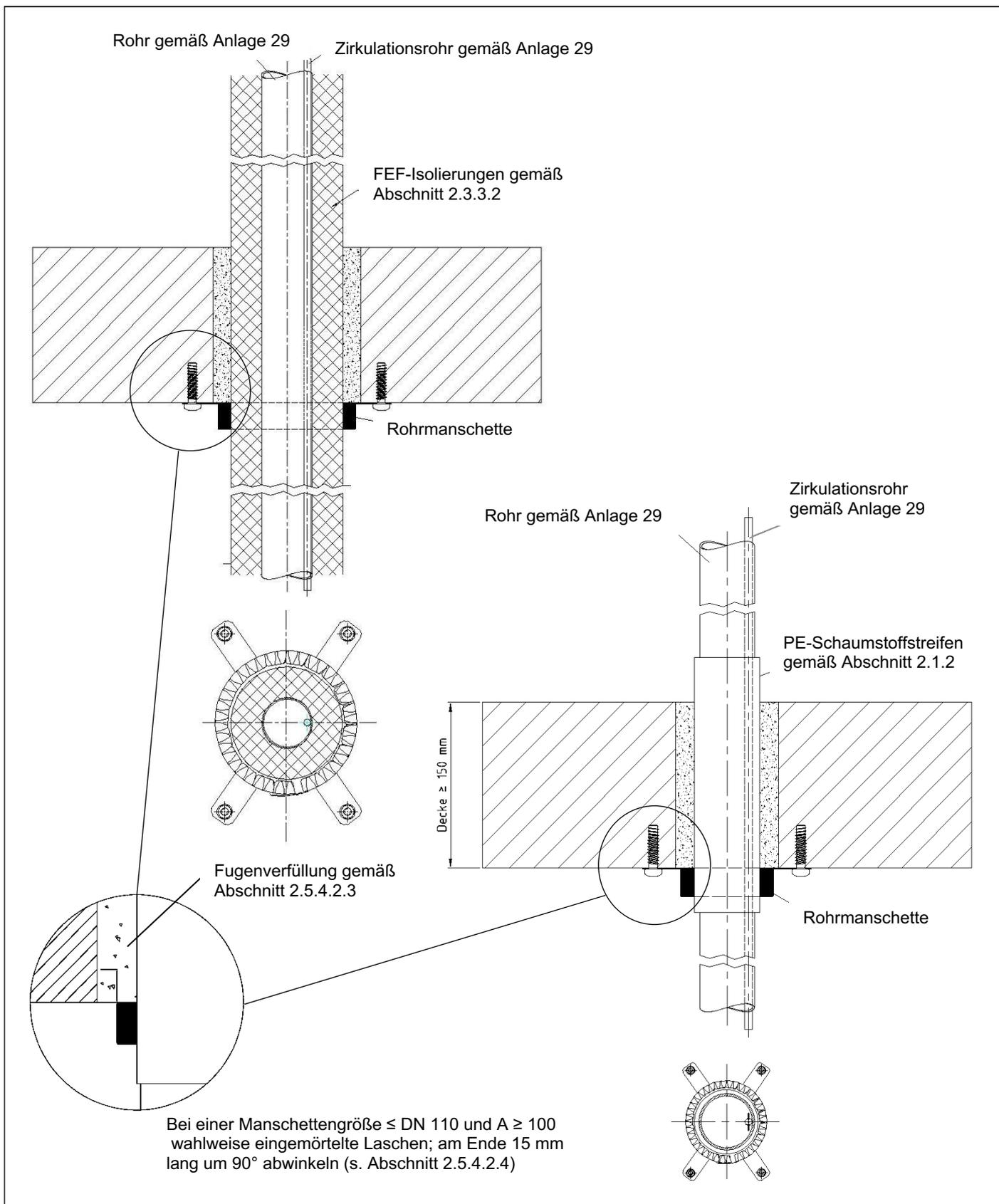
Feuerwiderstandsfähige Abschottung für Rohrleitungen aus Kunststoff "Curaflam System ECO Pro", "System FS-M R2", "System FSC", "System FS-Pro" bzw. "System FStop"
