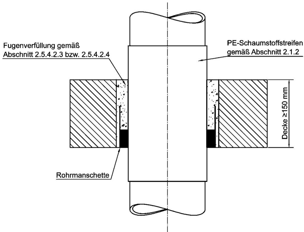
Feuerwiderstandsfähige Abschottung für Rohrleitungen aus Kunststoff "Curaflam System ECO Pro", "System FS-M R2", "System FSC", "System FS-Pro" bzw. "System FStop"
