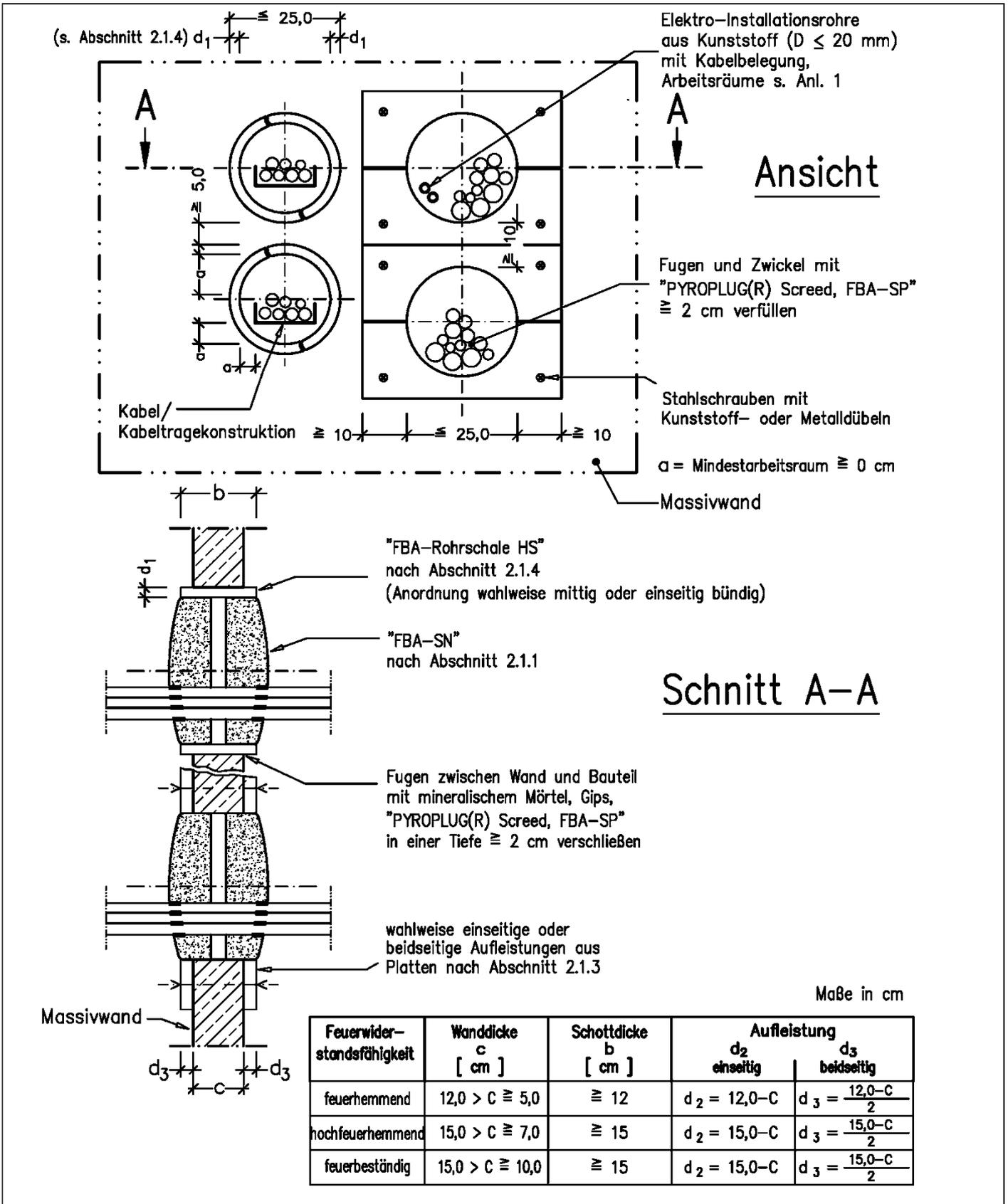
Feuerwiderstandsfähige Abschottung für elektrische Leitungen "PYROPLUG Peg"
