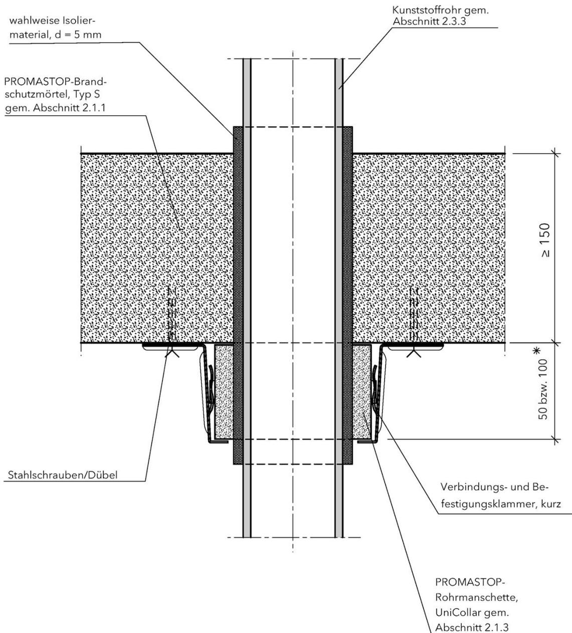
\* je nach Rohrmaterial und -durchmesser ein oder zwei Manschetten auf der Deckenunterseite hintereinander (s. Anlagen 3 und 4)
