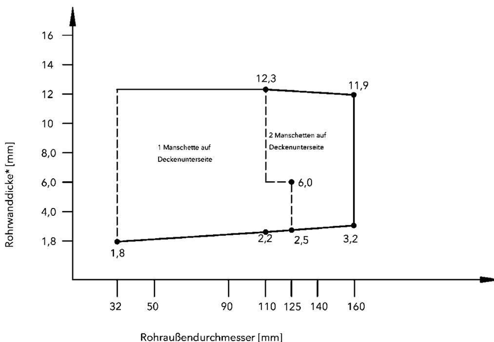
Rohre der Rohrgruppe B-2 gemäß Anlage 1 für Deckenabschottungen
