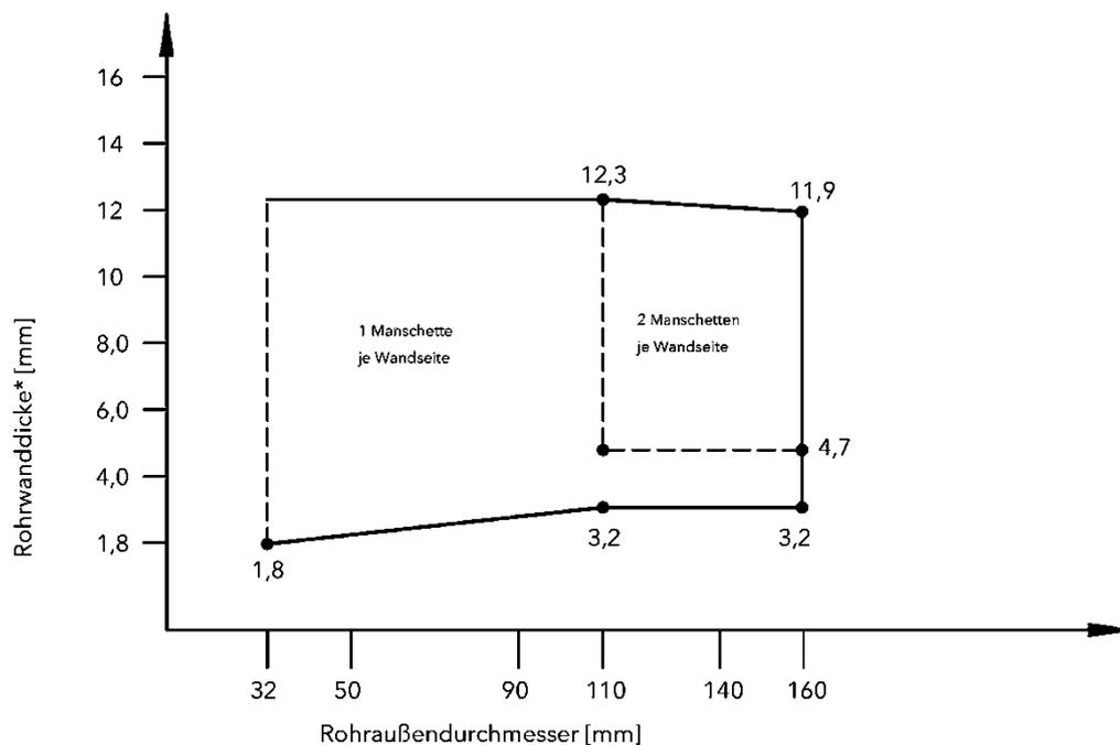
Rohre der Rohrgruppe B-1 gemäß Anlage 1 für Wandabschottungen
