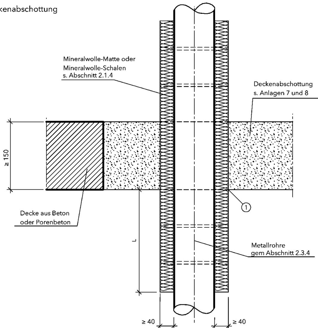
Befestigung der Rohrisolierung
