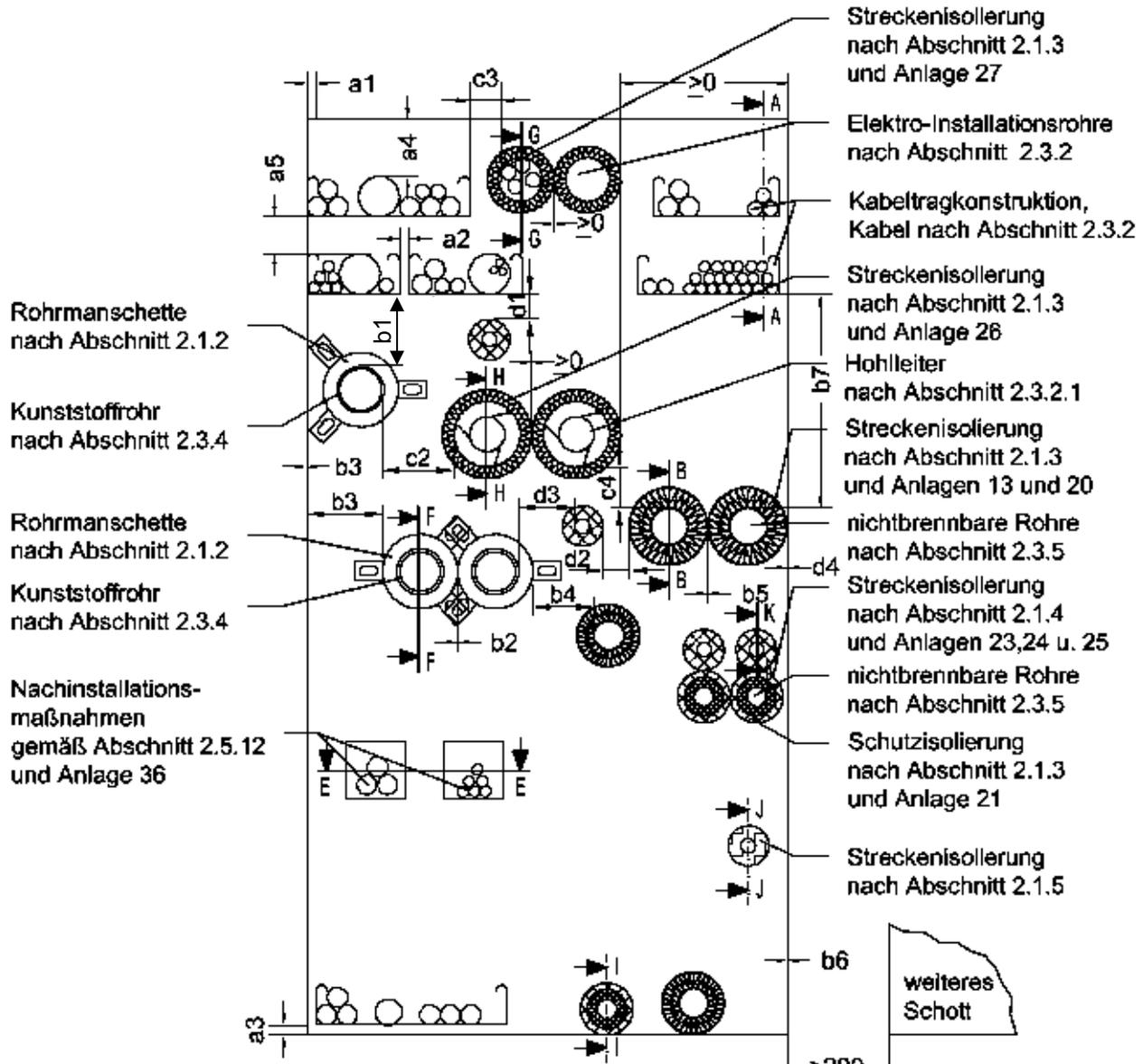
**Maximale Abmessungen der Abschottung:**
