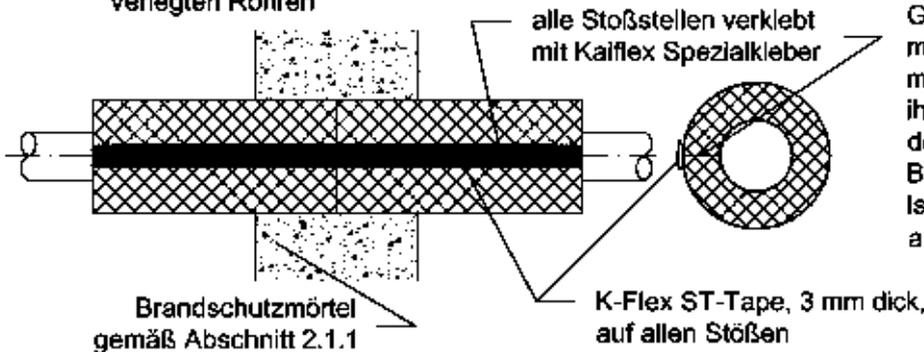
Geschlitzte Schläuche sind zusätzlich mit einem Draht,  $d > 1,4$  mm, mit 8 Umwicklungen je lfd. Meter in ihrer Lage zu sichern. Der Abstand der ersten Umwicklung zur Bauteiloberfläche bzw. zum Isolierungsende muss  $a \leq 50$  mm sein
