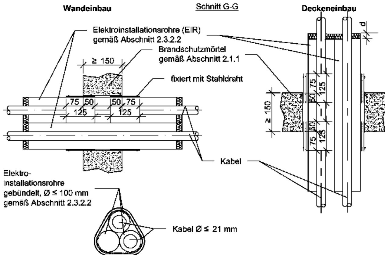
Einbau von starren und biegsamen Elektroinstallationsrohren (EIR) nach DIN EN 61386 bzw. DIN EN 50086 aus Kunststoff- oder Stahlqualitäten
