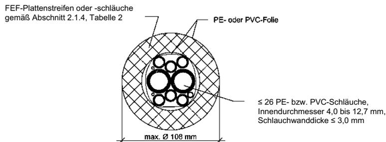
Feuerwiderstandsfähige Abschottung für elektrische Leitungen und/oder Rohrleitungen aus Kunststoff oder Metall "Würth-Kombischott 90"
