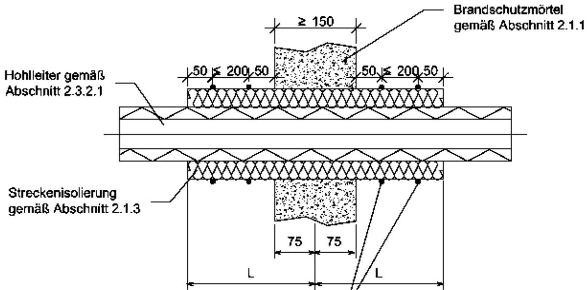
Koaxialkabel gemäß Abschnitt 2.3.2.1
