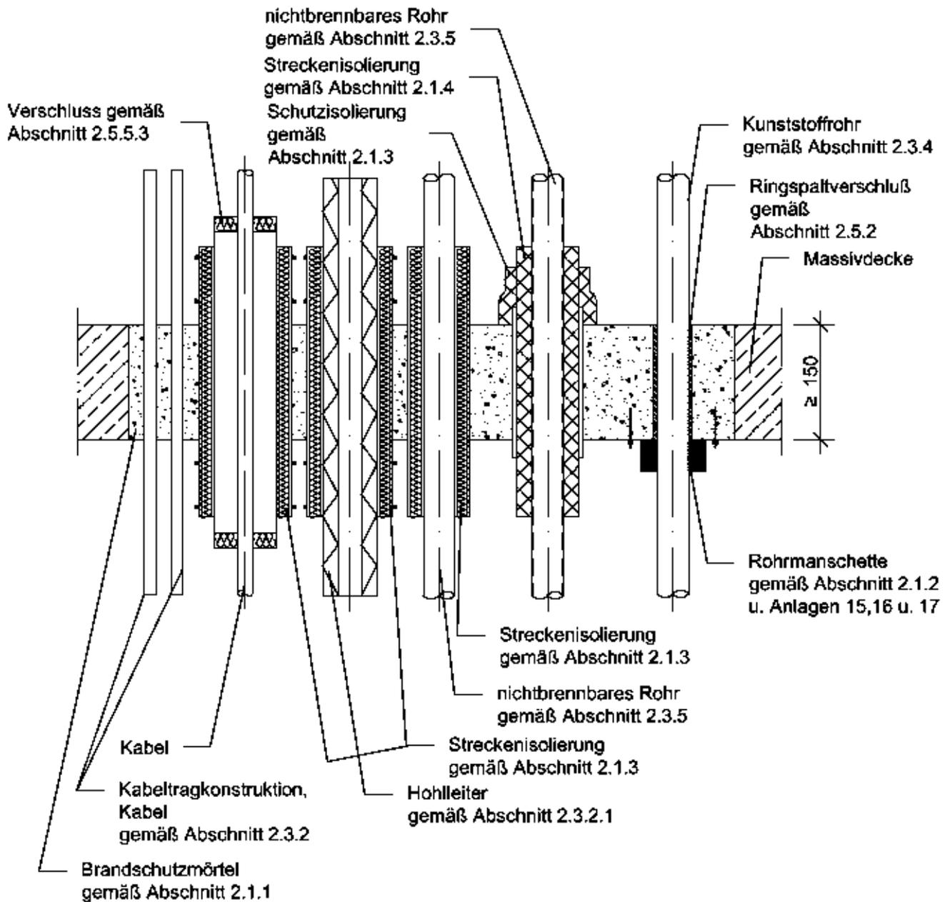
Feuerwiderstandsfähige Abschottung für elektrische Leitungen und/oder Rohrleitungen aus Kunststoff oder Metall "Würth-Kombischott 90"
