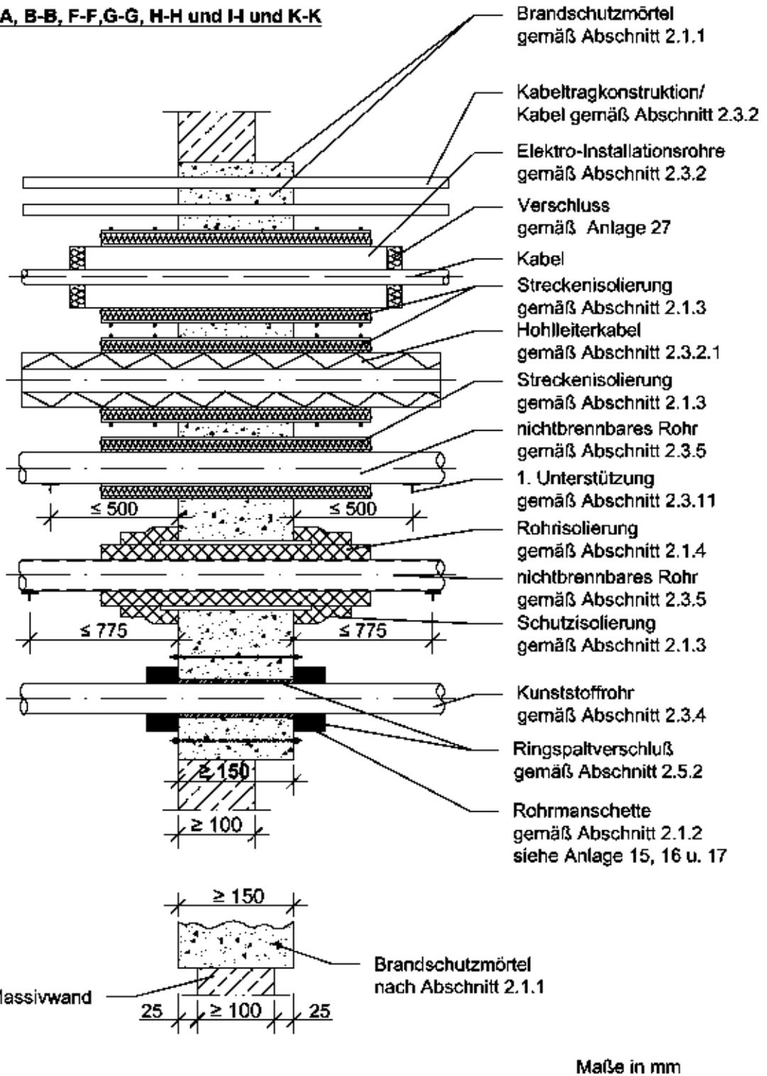
Feuerwiderstandsfähige Abschottung für elektrische Leitungen und/oder Rohrleitungen aus Kunststoff oder Metall "Würth-Kombischott 90"
