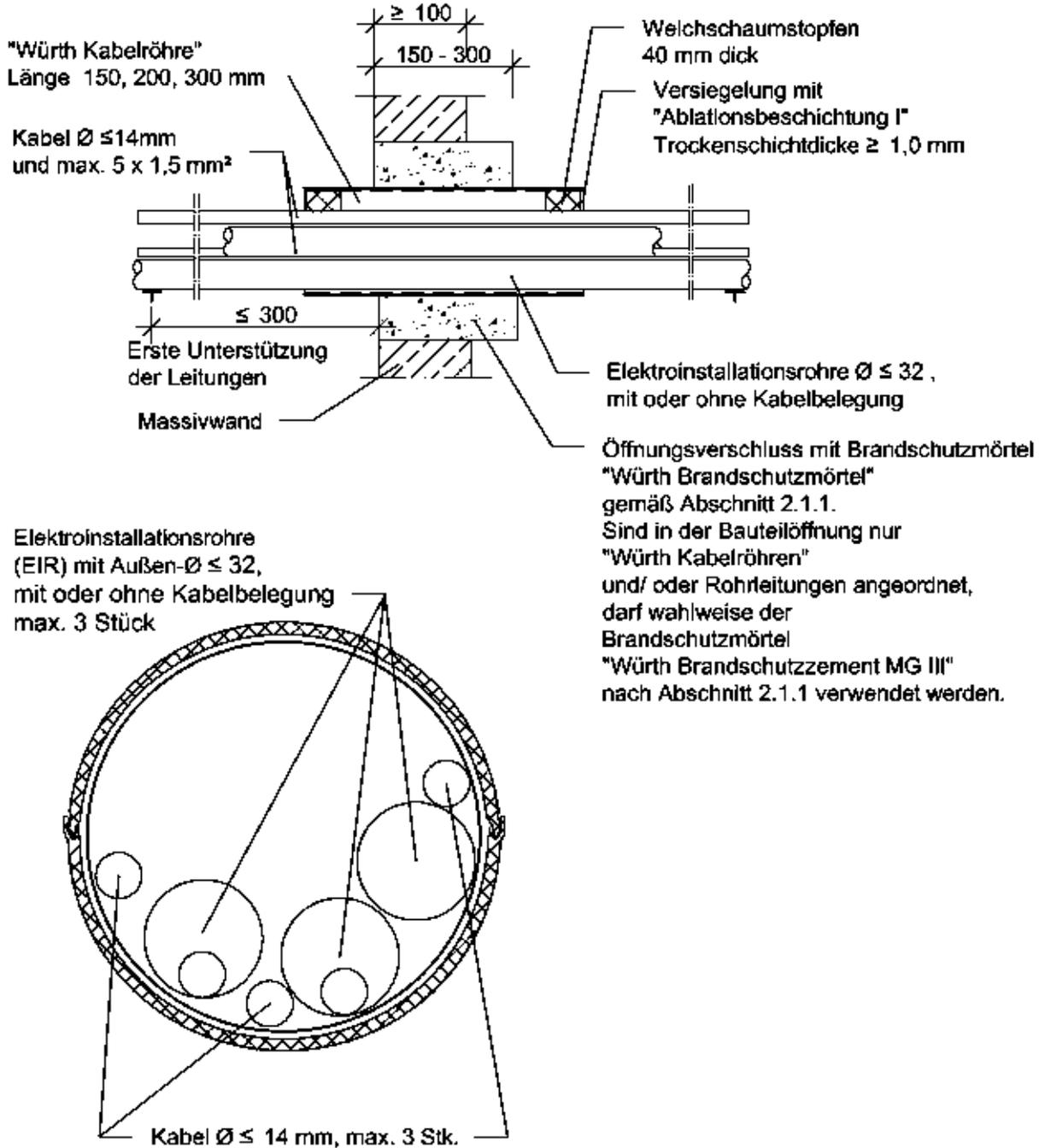
Feuerwiderstandsfähige Abschottung für elektrische Leitungen und/oder Rohrleitungen aus Kunststoff oder Metall "Würth-Kombischott 90"
