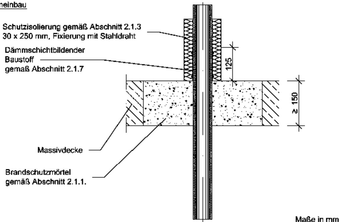
Feuerwiderstandsfähige Abschottung für elektrische Leitungen und/oder Rohrleitungen aus Kunststoff oder Metall "Würth-Kombischott 90"
