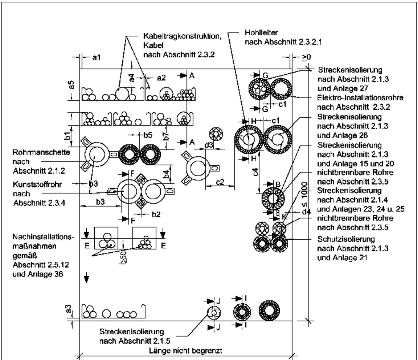
**Maximale Abmessungen der Abschottung**
