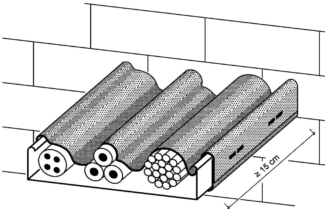
Kabel  $\varnothing > 18$  mm, Kabelbündel, Steuerleitungen aus Stahl und die zugehörigen Kabeltragekonstruktionen in hochfeuerhemmenden bzw. feuerbeständigen Abschottungen müssen profilfolgend auf beiden Seiten der Kabelabschottung auf einer Länge von 15 cm mit der Brandschutzbandage gem. Abschnitt 2.1.3 umwickelt werden.
