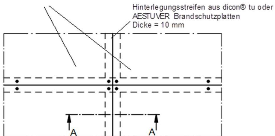
**Einbauzustand: Schnitt A-A**
