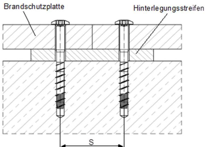
HECO MULTI-MONTI-Schraubanker MMS-P zur Mehrfachbefestigung
