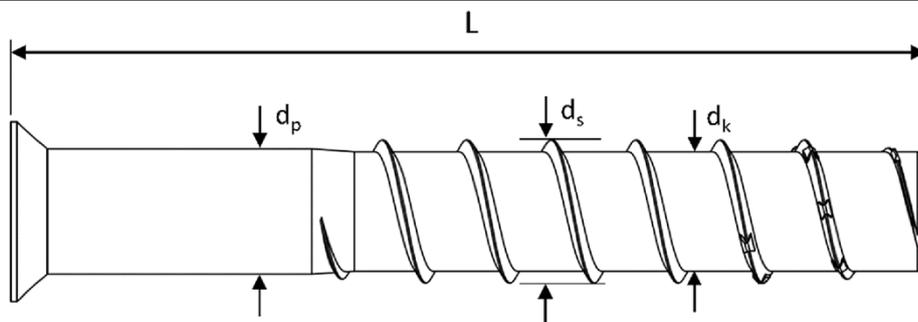
TOGE Betonschrauben TSM als Verbundankerschraube zur Verankerung im Beton
