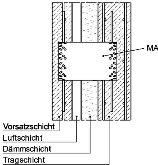
**Einbau Sandwichanker FA**
