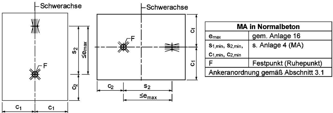
**Beispiele Anordnung Sandwichanker FA in Normalbeton**
