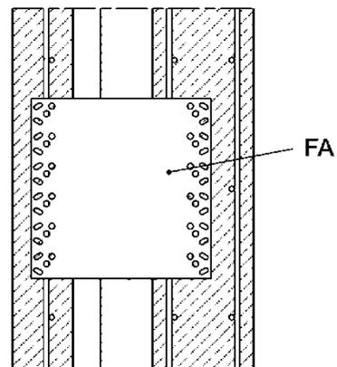
PHILIPP Sandwichanker MA und FA zur Verankerung von Vorsatzschalen an Tragschichten
