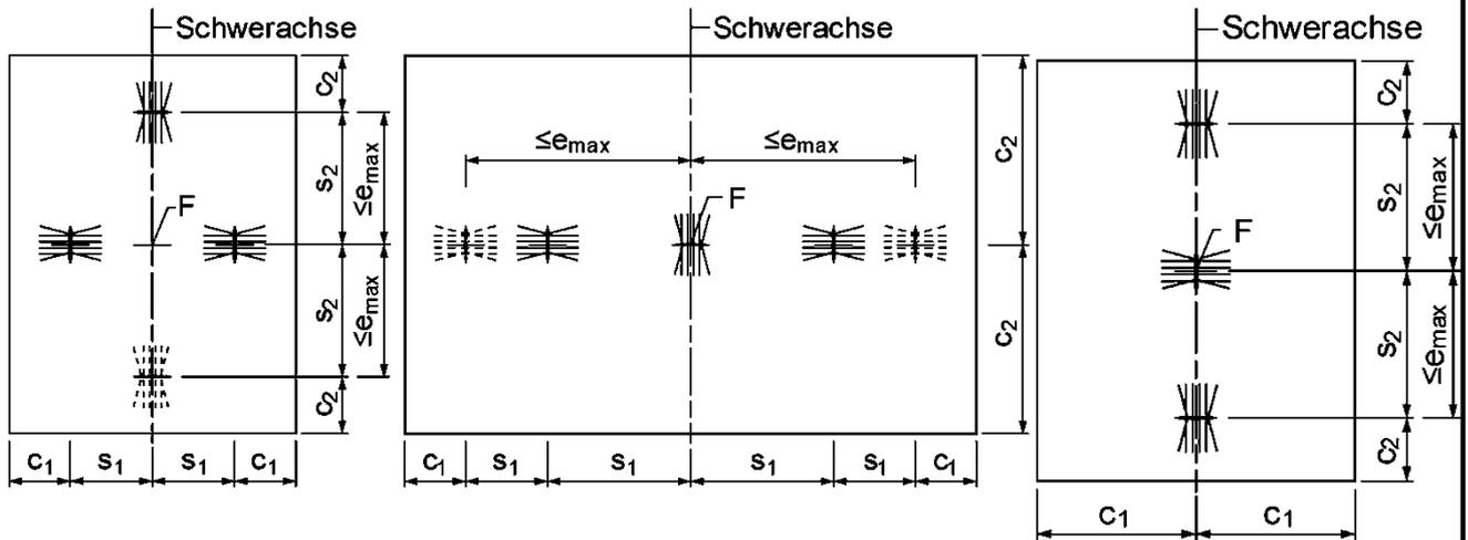
**Beispiel: Anordnung Sandwichanker FA mit Verbundnadel VN bei Verwendung als Traganker unter Querkraft mit Momentenbeanspruchung in gefügedichtetem Leichtbeton**
