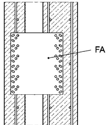
**Einbau Sandwichanker MA**
