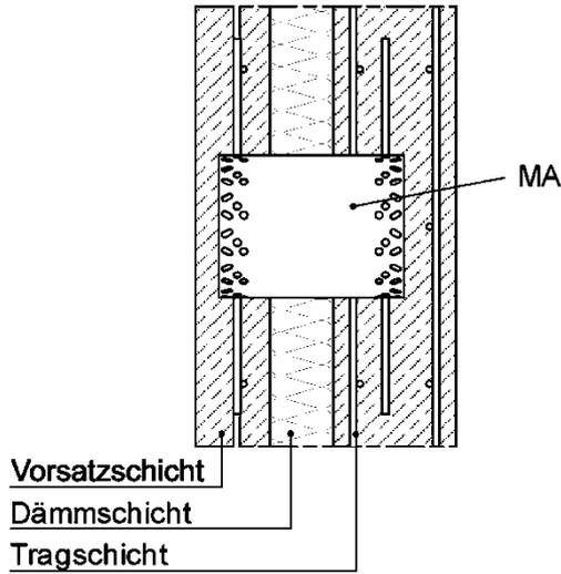
**Einbau Sandwichanker FA**
