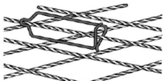
Bild 8: SPA-B unter den oberen Mattenstab führen.
