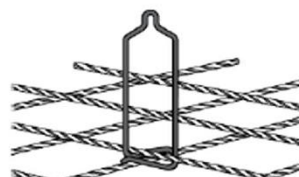
Bild 10: SPA-B Schenkel zusammendrücken und drehend am unteren Mattenstab anklicken.
