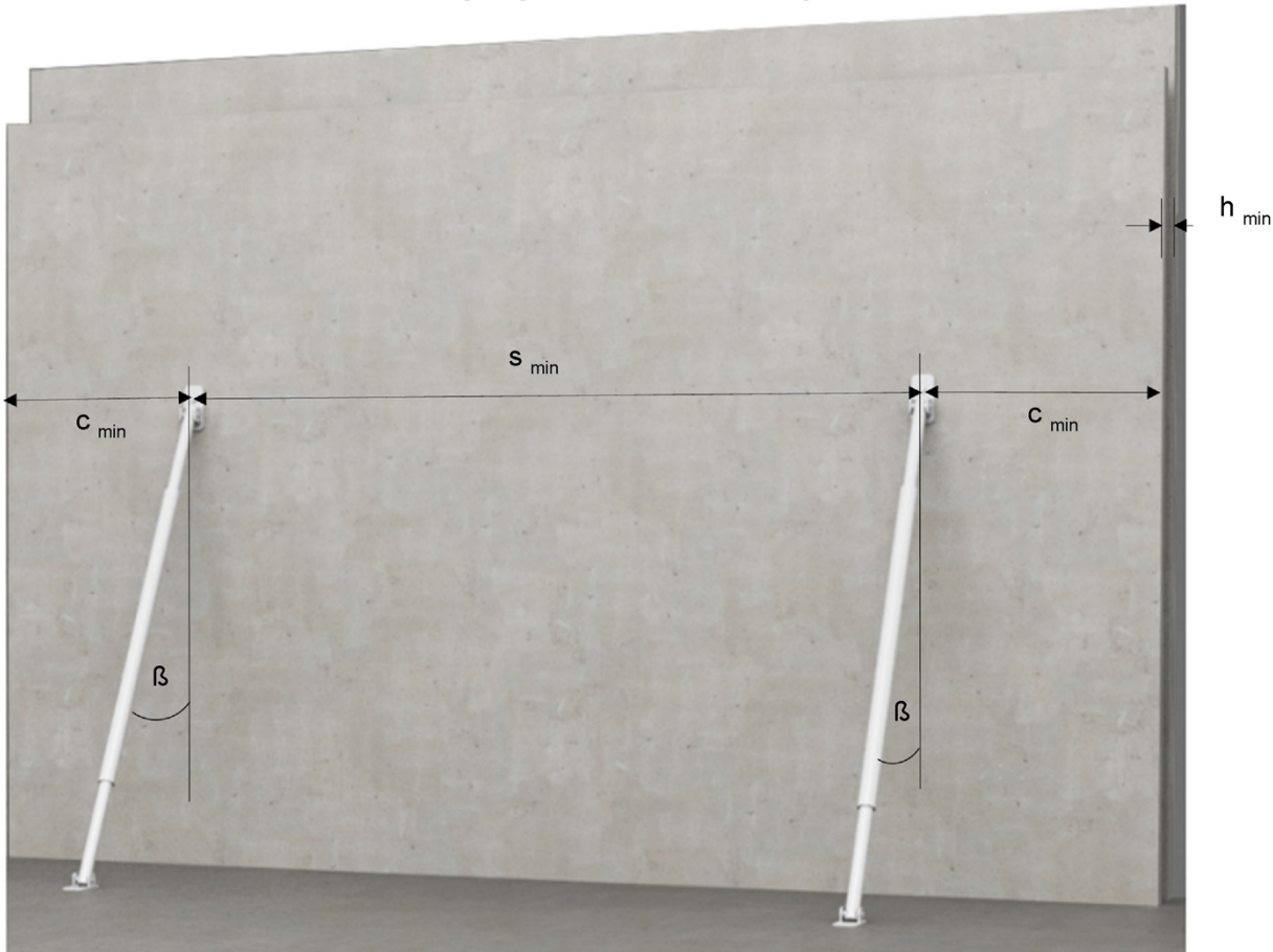
Bild A10: Mindestabstände, Neigungswinkel der Schrägstützen/Richtstreben
