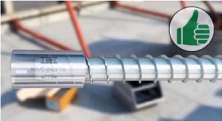
Bilder A20-21: Überprüfung der Wiederverwendbarkeit des Schraubankers
