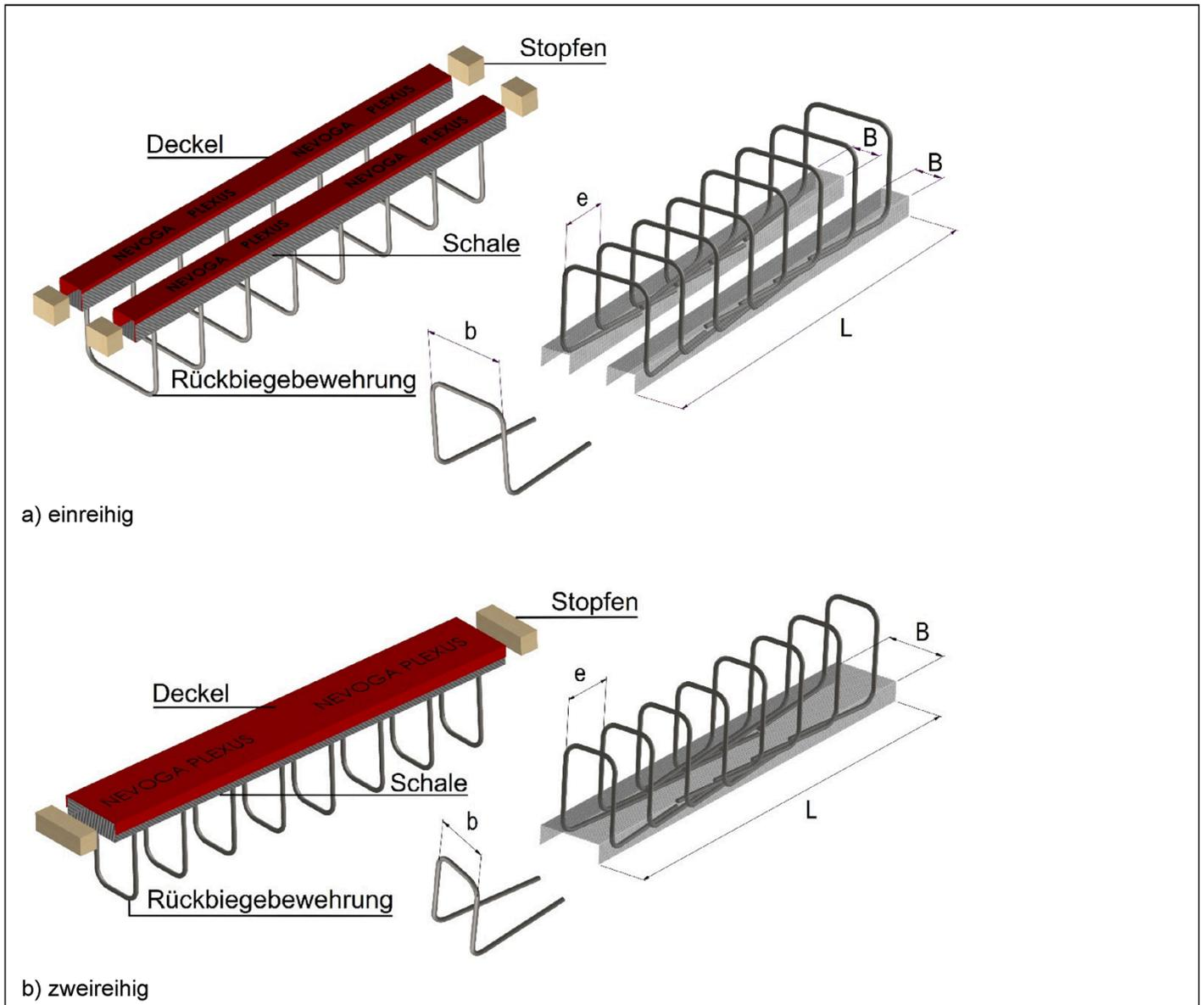
**Abbildung 2:** Aufbau Rückbiegeanschlusselemente
