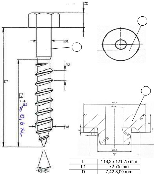
Bild 11: UNI-Bau Vibra-Schraube 1081209 8 x 120 mm
