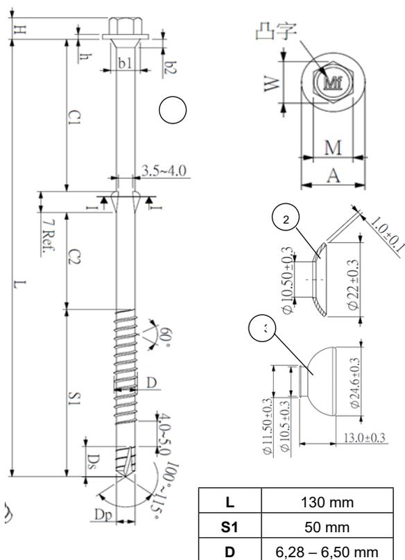
**Bild 10: Shen Fung Spezialbohrschraube 6,5 x 130 mm**
