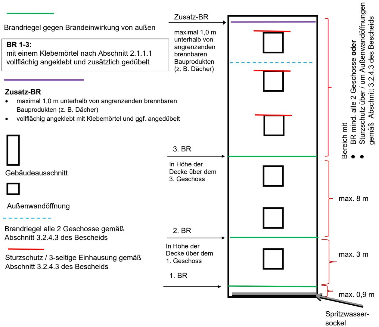
Anordnung der konstruktiven Brandschutzmaßnahmen
