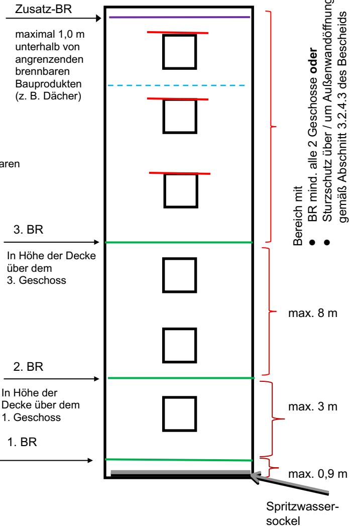
**Sturzausbildung bei Verwendung der Dämmplatten**
