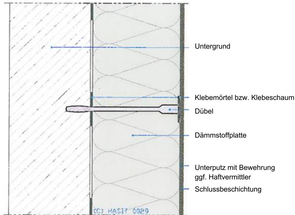
**"HASITHERM MW Dickputzsystem geklebt und gedübelt":**
