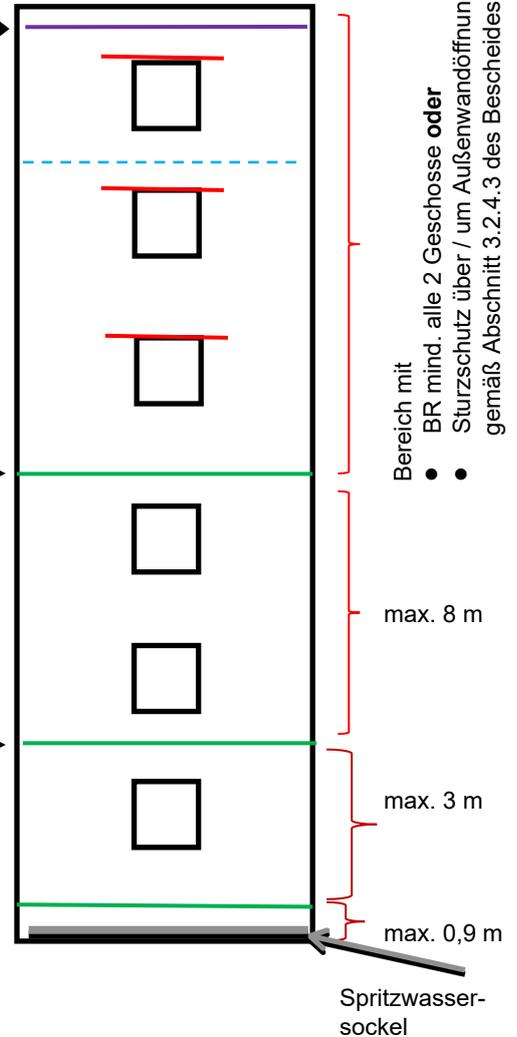
**Erklärung für die Bauart "WDVS" an Außenwänden**
