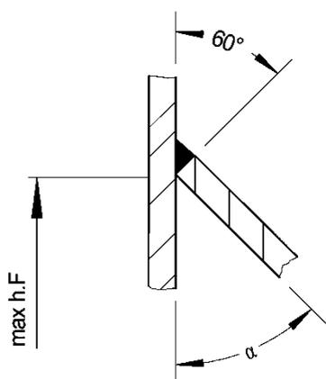
A)  $\alpha \geq 60^\circ$  :  $f \geq 0,2 t.DR$  ;  $a \geq 0,7 t.z$  (WE,WZ)
