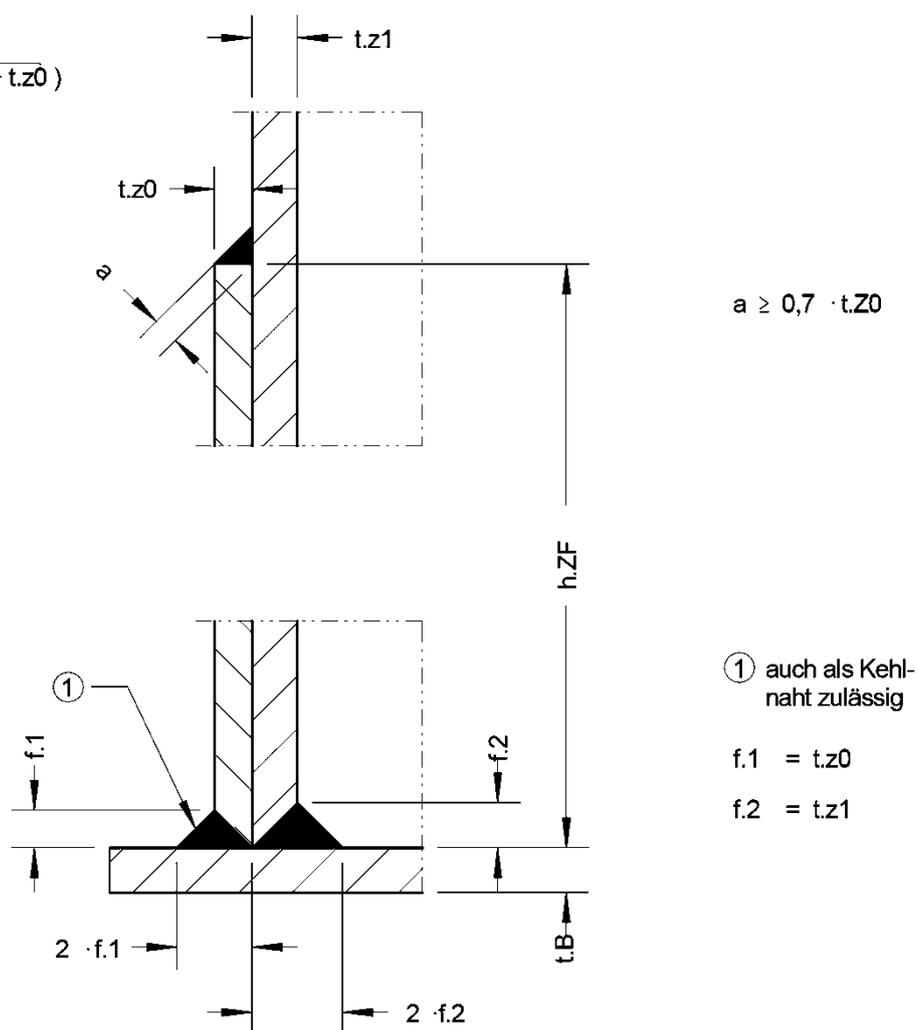
Zylindrische Flachbodenbehälter und Auffangvorrichtungen aus Polyethylen (PE) mit Zylindermänteln aus verschweißten Tafeln (Tafelbehälter)
