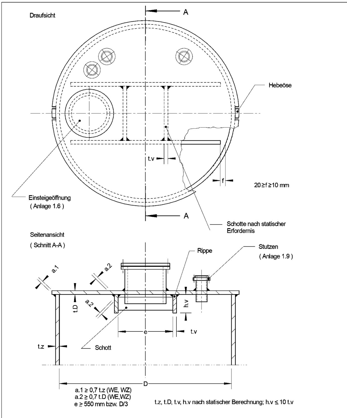
Zylindrische Flachbodenbehälter und Auffangvorrichtungen aus Polyethylen (PE) mit
