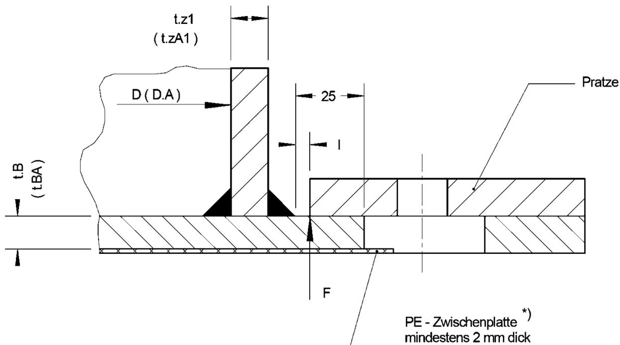
\*) Zwischenplatte nur bei Behältern erforderlich, die nicht in Auffangvorrichtungen nach dieser allgemeinen bauaufsichtlichen Zulassung aufgestellt werden.
