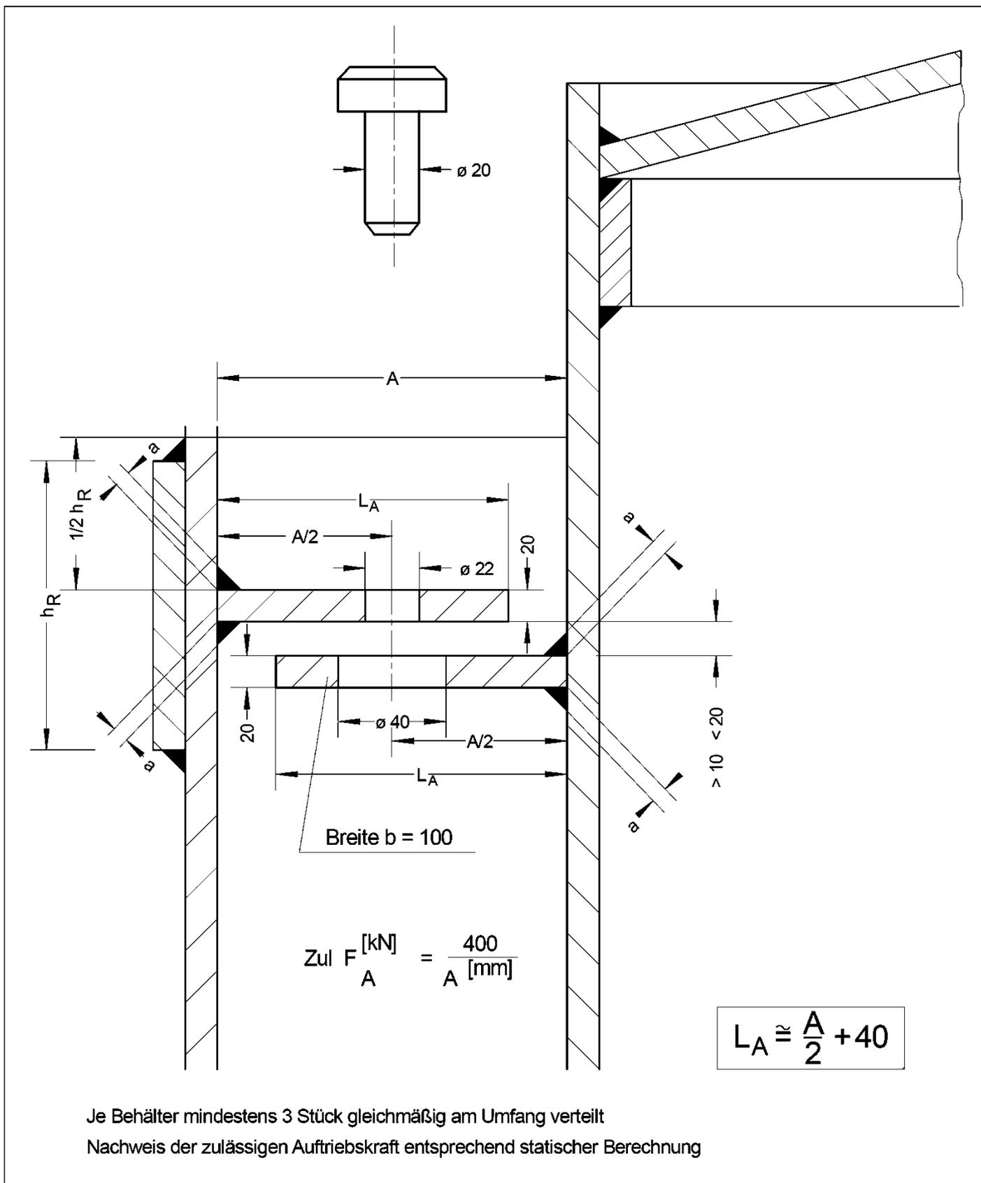
Zylindrische Flachbodenbehälter und Auffangvorrichtungen aus Polyethylen (PE) mit Zylindermänteln aus verschweißten Tafeln (Tafelbehälter)
