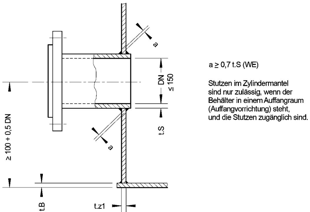
Zylindrische Flachbodenbehälter und Auffangvorrichtungen aus Polyethylen (PE) mit Zylindermänteln aus verschweißten Tafeln (Tafelbehälter)
