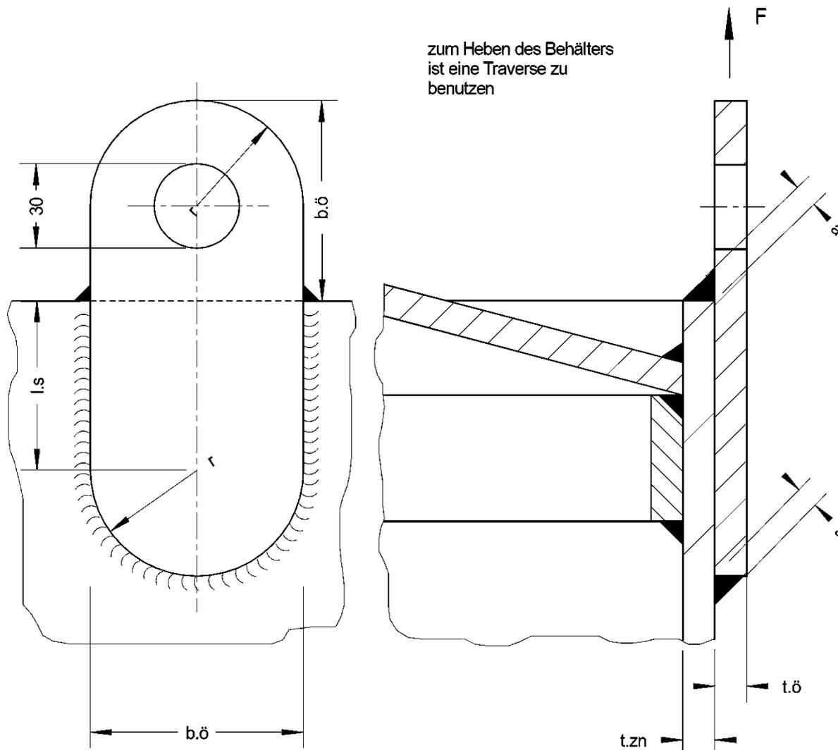
Hebeöse für Auffangvorrichtung ist analog auszuführen (auch an Innenseite des Zylinders möglich)
