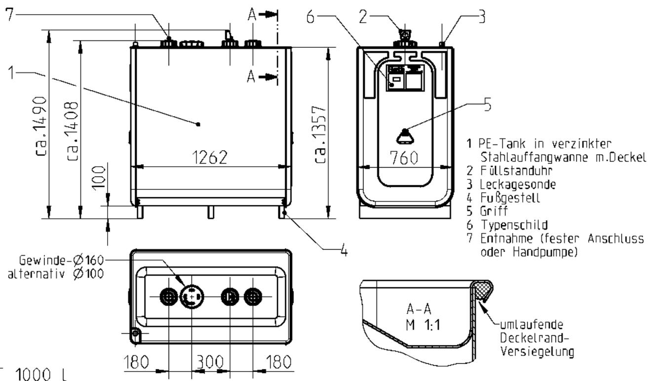
Blasgeformte Behälter aus Polyethylen (PE-HD) mit integrierter Stahlblechauffang-
