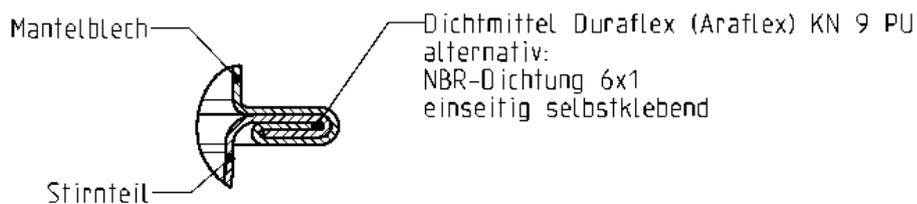
Bördelnaht mit Dichtung
