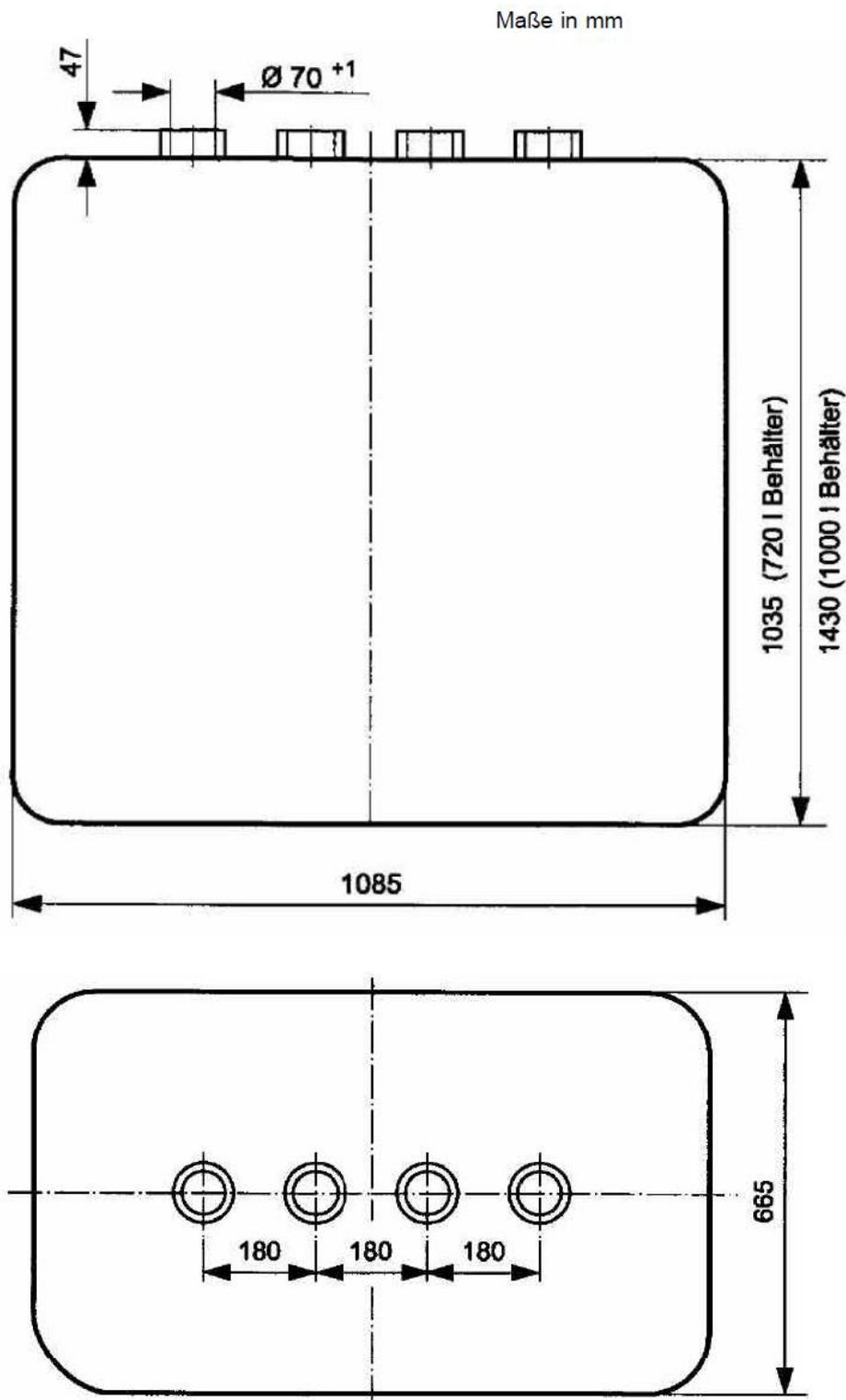
Blasgeformte Behälter aus Polyethylen (PE-HD)
