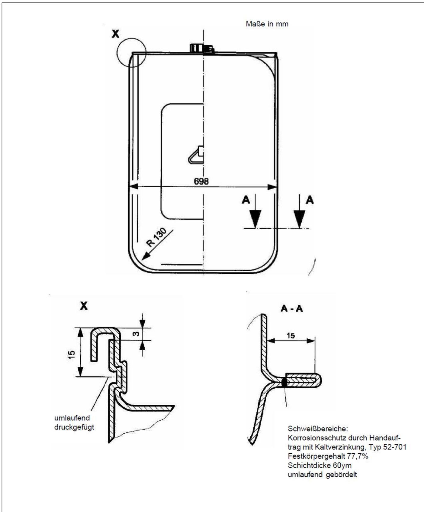
Blasgeformte Behälter aus Polyethylen (PE-HD)
