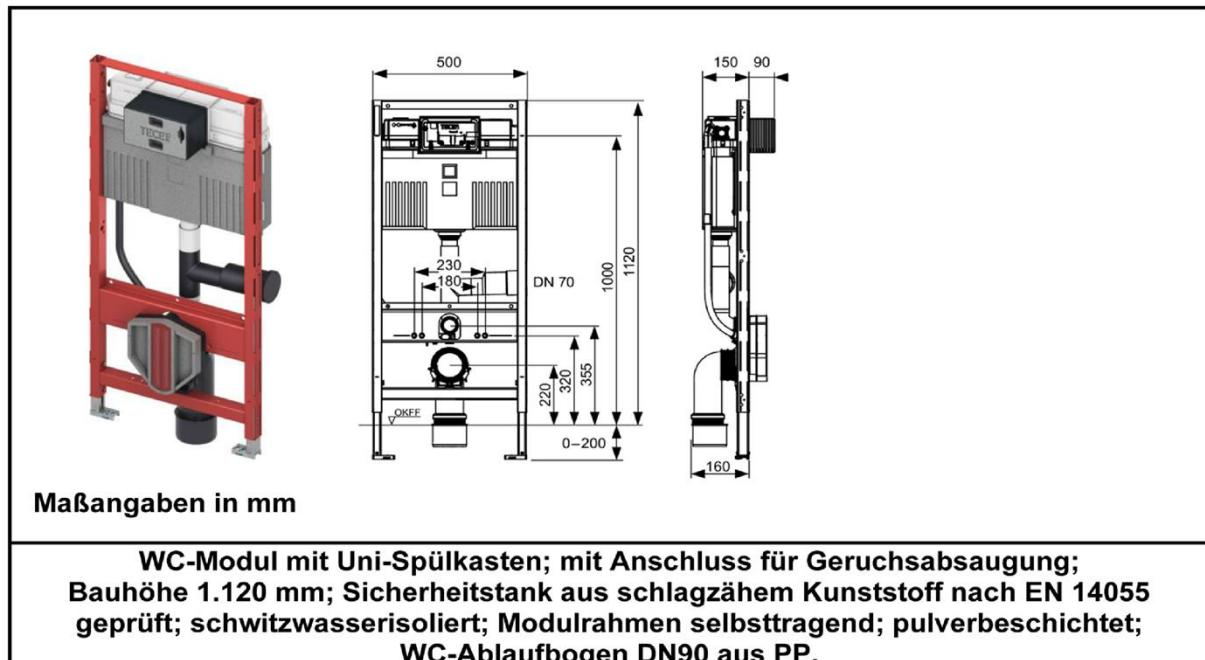
**"TECEprofil"-WC-Gerontomodul mit Uni-Spülkasten; Bauhöhe 1.120 mm**
