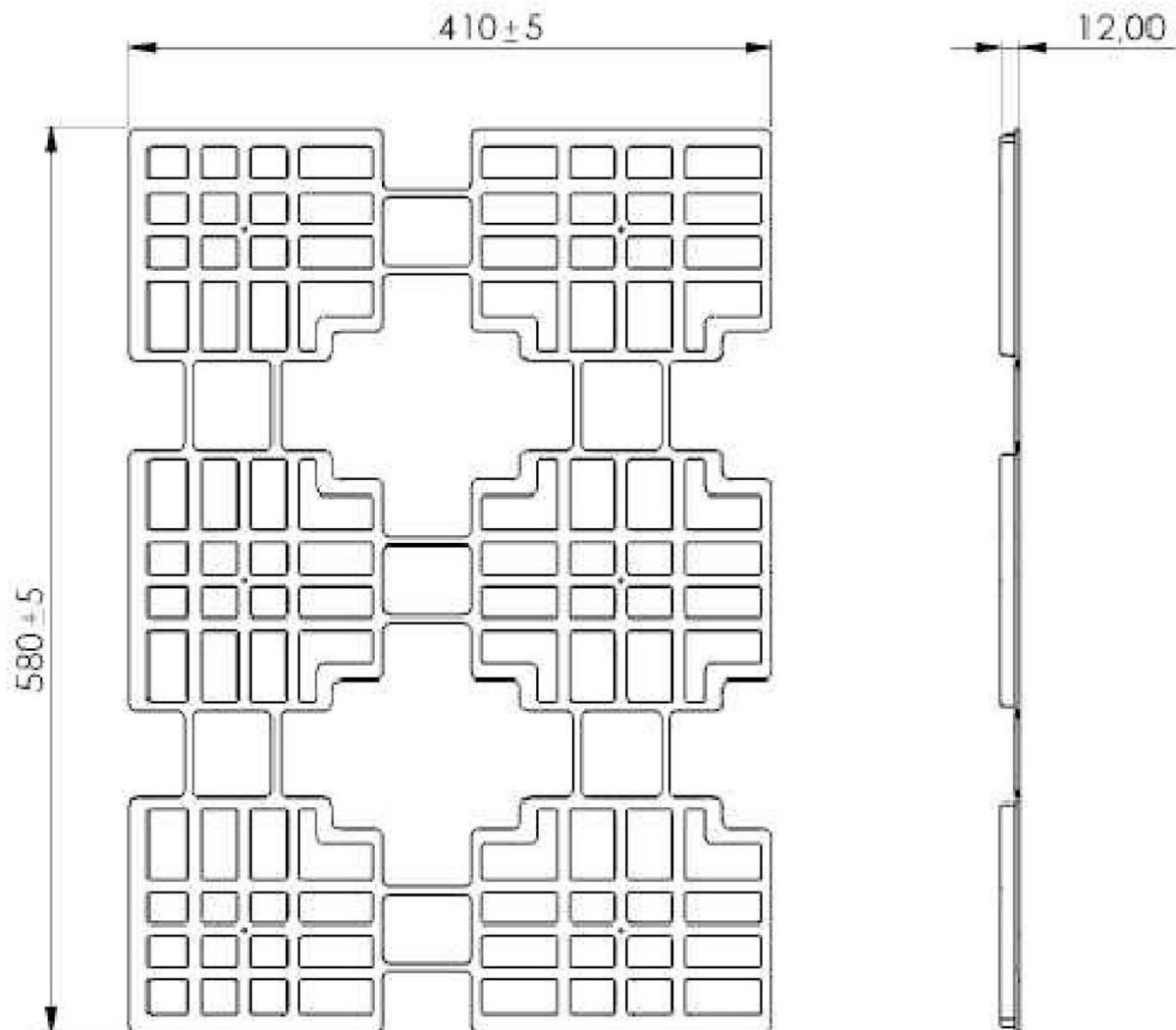
Versickerungsblöcke zur Errichtung v. Versickerungs- u. Rückhalteanlagen für Niederschlagswasser m. d. Bezeichnung "ENREGIS/X-Box®, ENREGIS/X-Box® Channel, ENREGIS/X-Box® VC, ENREGIS/Controlbox® u. ENREGIS/Controlbox® GF" System
