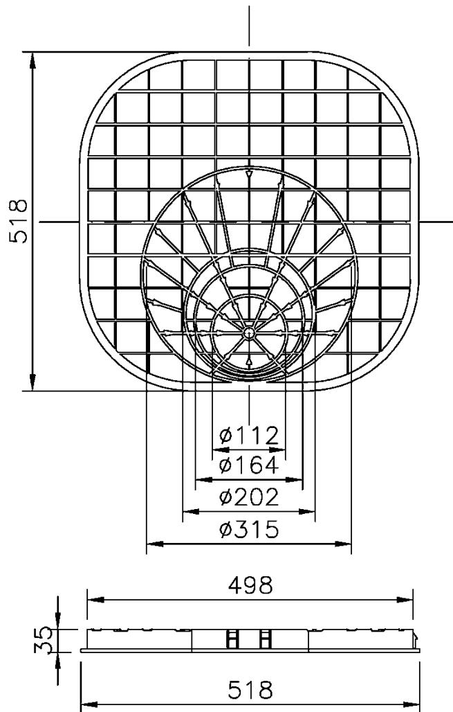
Versickerungsblöcke zur Errichtung v. Versickerungs- u. Rückhalteanlagen für Niederschlagswasser m. d. Bezeichnung "ENREGIS/X-Box® Channel, ENREGIS/X-Box® VC, ENREGIS/Controlbox® u. ENREGIS/Controlbox® GF" System
