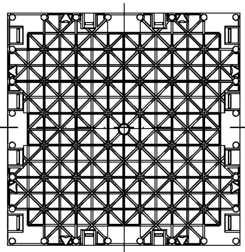
Versickerungsblöcke zur Errichtung v. Versickerungs- u. Rückhalteanlagen für Niederschlagswasser m. d. Bezeichnung "ENREGIS/X-Box® Channel, ENREGIS/X-Box® VC, ENREGIS/Controlbox® u. ENREGIS/Controlbox® GF" System
