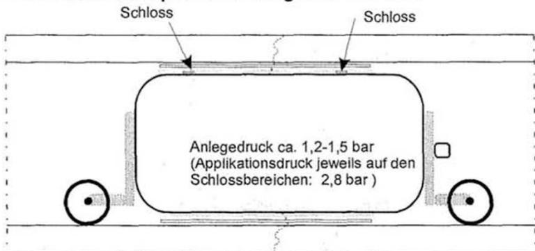
**Bild3: "Quick-Lock" Manschette nach dem Versetzen**
