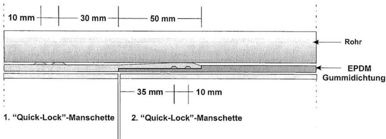
Innenrohr- oder Schlauchlinerendmanschette mit der Bezeichnung "Quick-Lock" zur Sanierung erdverlegter Abwasserleitungen der Nennweiten DN 150 bis DN 700
