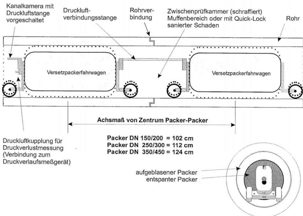
Innenrohr- oder Schlauchlinerendmanschette mit der Bezeichnung "Quick-Lock" zur Sanierung erdverlegter Abwasserleitungen der Nennweiten DN 150 bis DN 700
