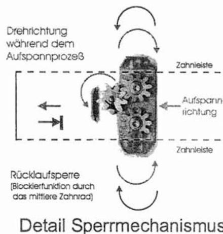
Innenrohr- oder Schlauchlinerendmanschette mit der Bezeichnung "Quick- Lock" zur Sanierung erdverlegter Abwasserleitungen der Nennweiten DN 150 bis DN 700
