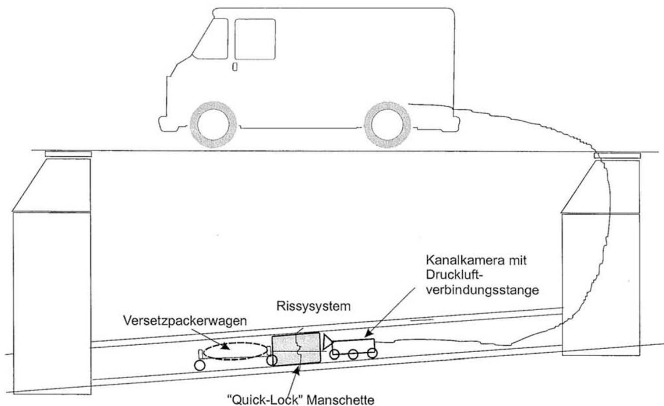
Innenrohr- oder Schlauchlinerendmanschette mit der Bezeichnung "Quick-Lock" zur Sanierung erdverlegter Abwasserleitungen der Nennweiten DN 150 bis DN 700
