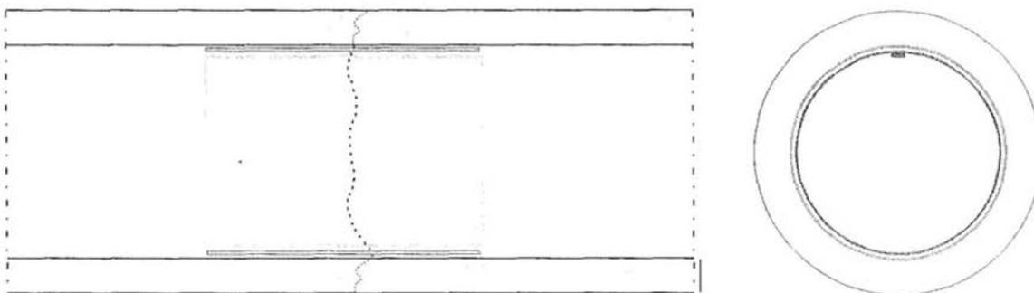
Innenrohr- oder Schlauchlinerendmanschette mit der Bezeichnung "Quick-Lock" zur Sanierung erdverlegter Abwasserleitungen der Nennweiten DN 150 bis DN 700
