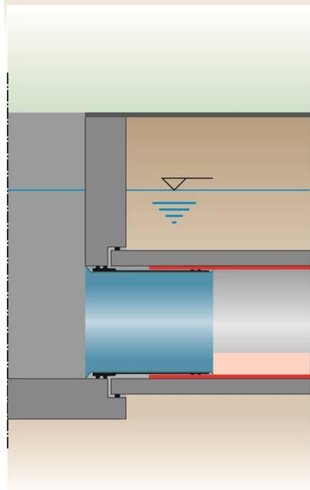
Innenrohr- oder Schlauchlinerendmanschette mit der Bezeichnung "Quick-Lock" zur Sanierung erdverlegter Abwasserleitungen der Nennweiten DN 150 bis DN 700
