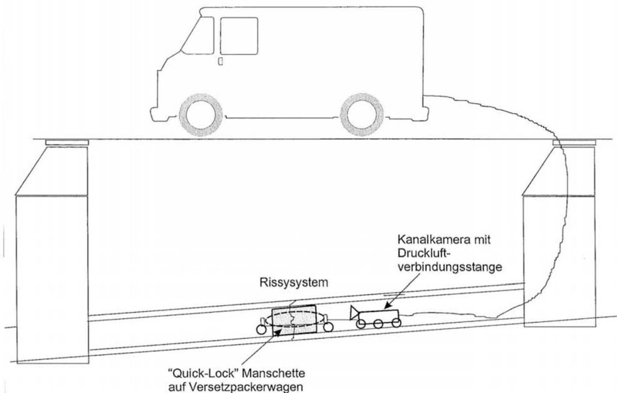
Innenrohr- oder Schlauchlinerendmanschette mit der Bezeichnung "Quick-Lock" zur Sanierung erdverlegter Abwasserleitungen der Nennweiten DN 150 bis DN 700
