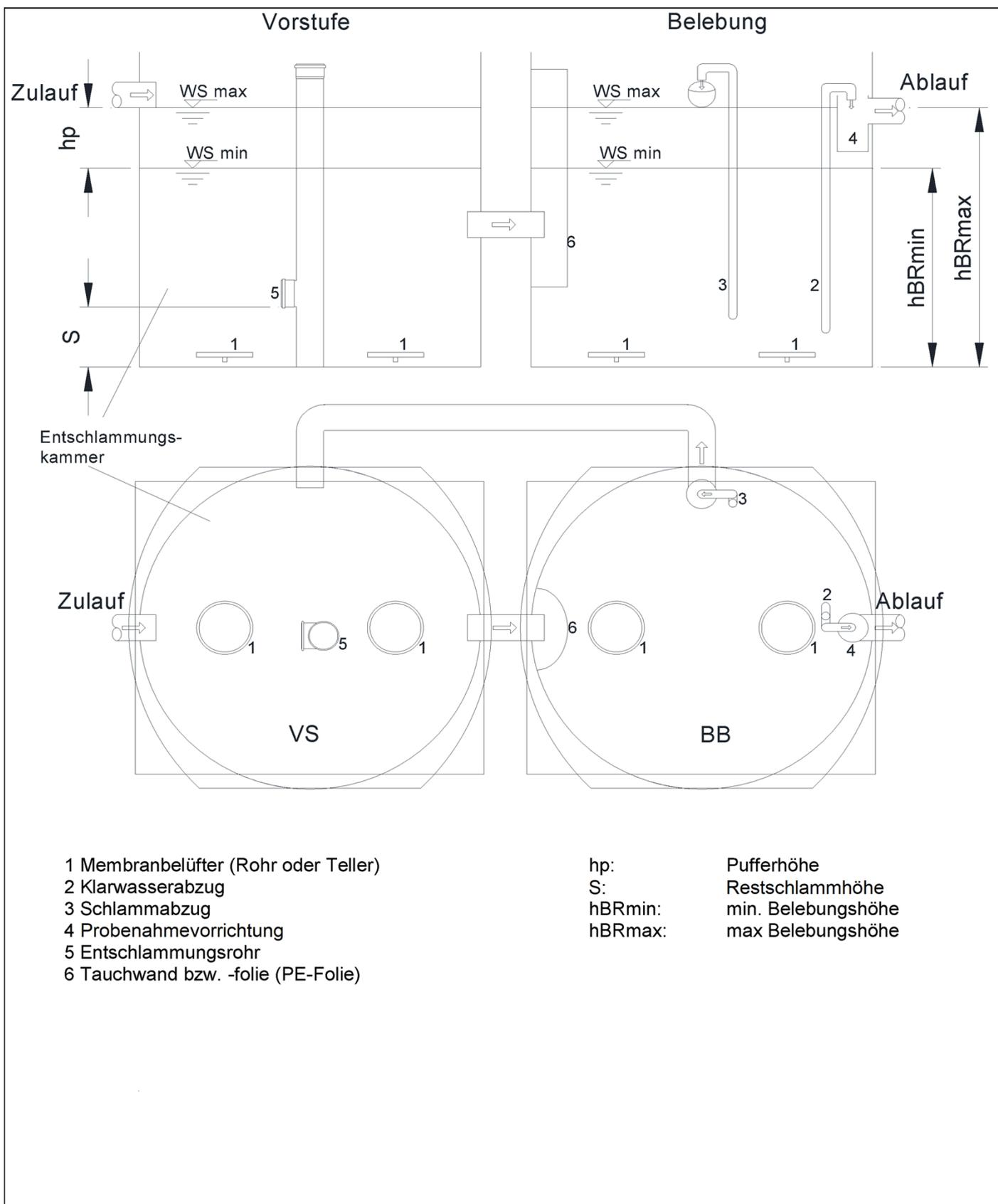
Nachrüstatz Typ KLARO One für den Einbau in bestehende Abwasserbehandlungsanlagen zur Herstellung von Kleinkläranlagen von 4 bis 50 EW; Ablaufklasse C
