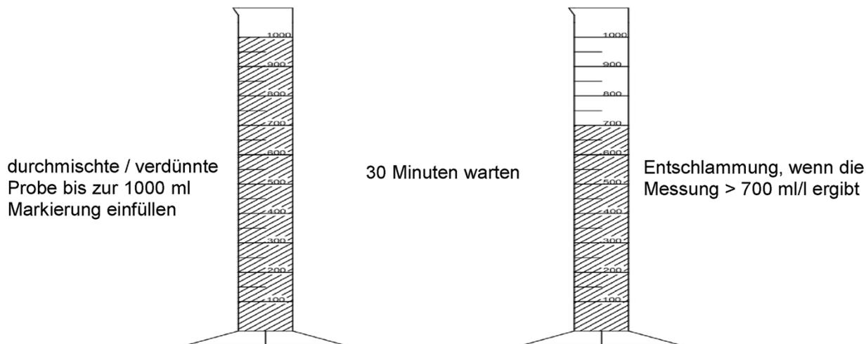
In den 2. Messzylinder wird parallel eine verdünnte Probe angesetzt. Die Verdünnung sollte nach unserer Empfehlung im Verhältnis 1+2 liegen (330 ml Schlamm und 670 ml Ablauf). Der abgelesene Wert ist dann mit dem Verdünnungsfaktor 3 zu multiplizieren).
