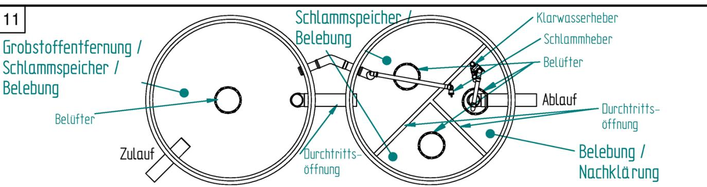
Alle Kammern können auch separate, in unterschiedlicher Form und Größe ausgebildete Behälter sein. Zu- und Abläufe der Nachrüstung sind der entsprechenden Ausführung anzupassen. Einzelne Kammern bzw. Behälter können, falls es sich aus der klärtechnischen Berechnung ergibt, stillgelegt werden. Auch andere Behältermaterialien in anderen Formen und Größen sind unter Einhaltung der Mindestvolumina nutzbar.
