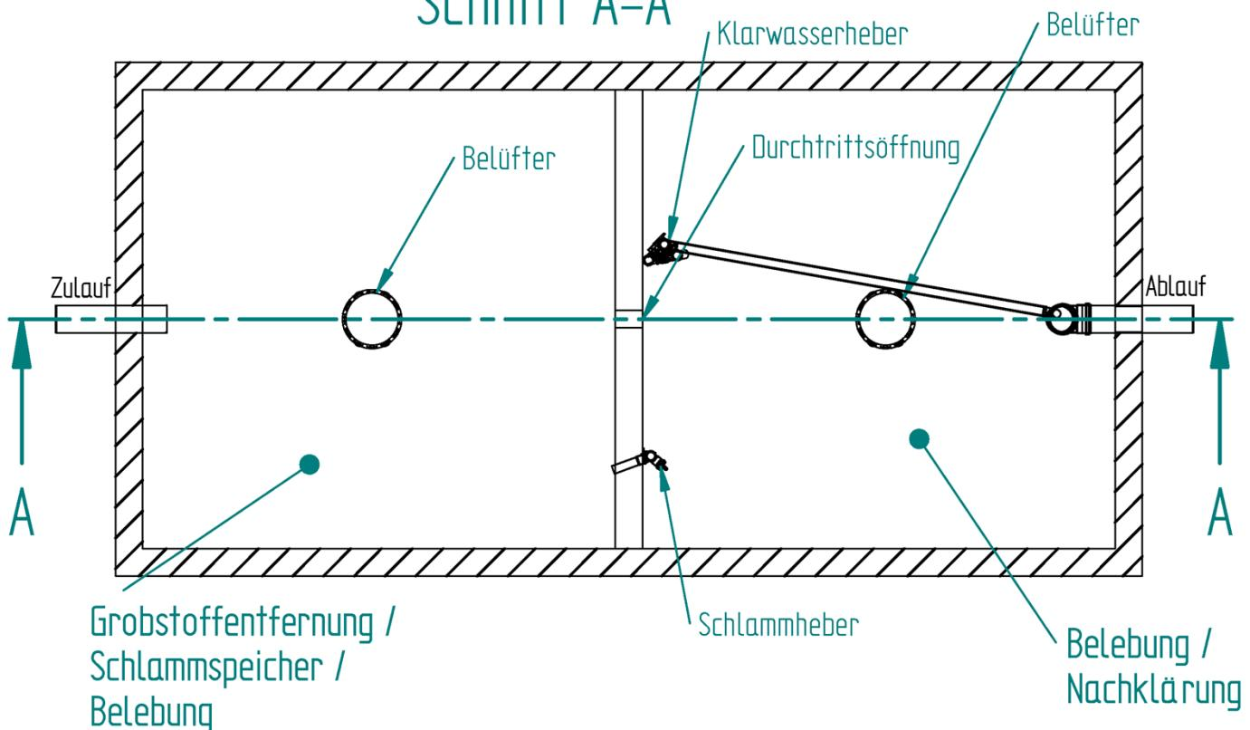
Alle Kammern können auch separate, in unterschiedlicher Form und Größe ausgebildete Behälter sein. Zu- und Abläufe der Nachrüstung sind der entsprechenden Ausführung anzupassen. Einzelne Kammern bzw. Behälter können, falls es sich aus der klärtechnischen Berechnung ergibt, stillgelegt werden. Auch andere Behältermaterialien in anderen Formen und Größen sind unter Einhaltung der Mindestvolumina nutzbar.
