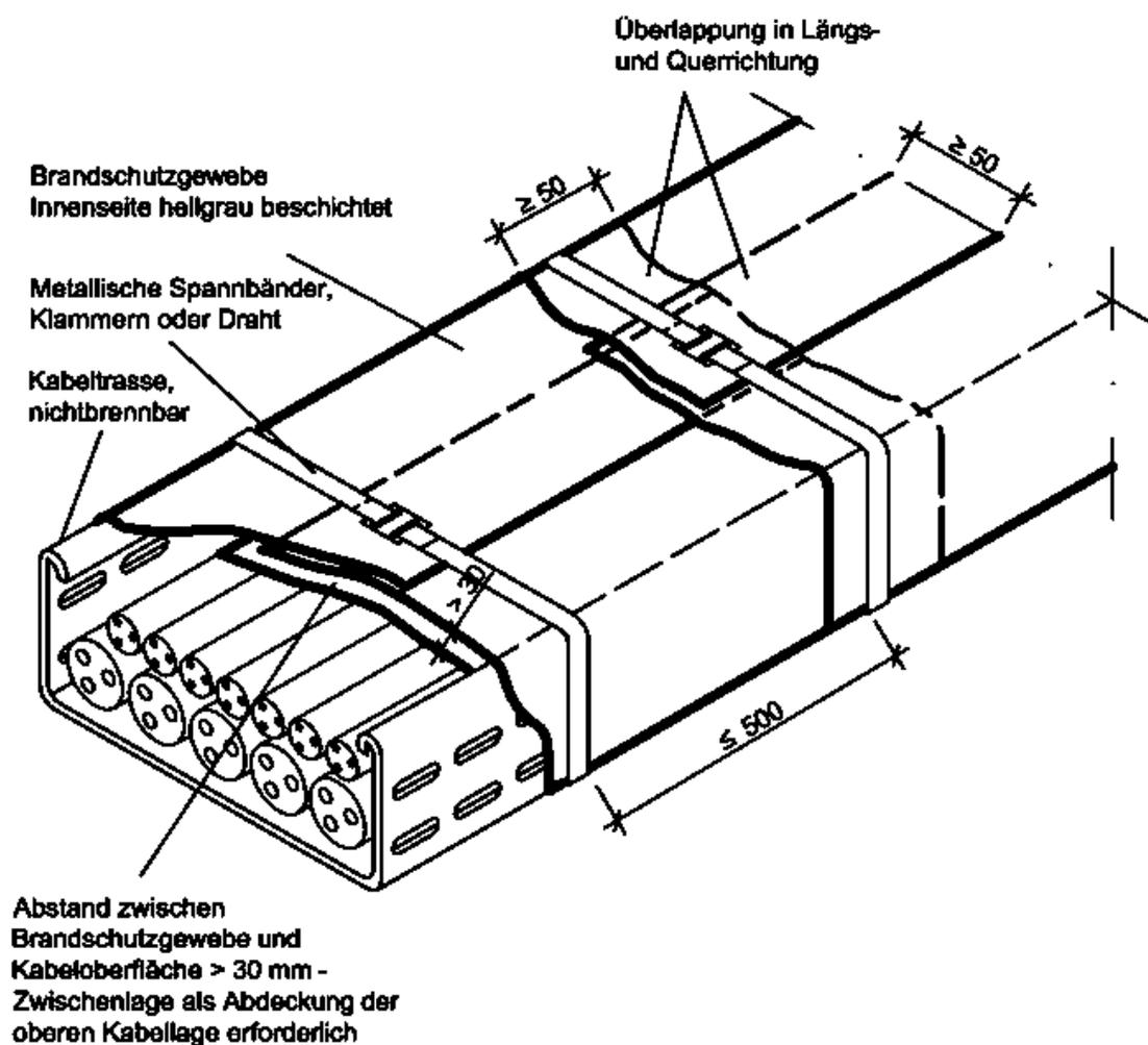
Umhüllungen von elektrischen Leitungen und Leitungsanlagen mit dem Brandschutzgewebe "DG-CR LS"
