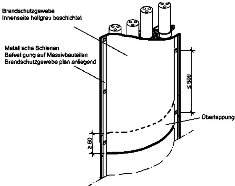
Ausführung von Kabeln- bzw. Ausgängen bei Anwendungen gemäß Abschnitt 1.2 (1) b)
