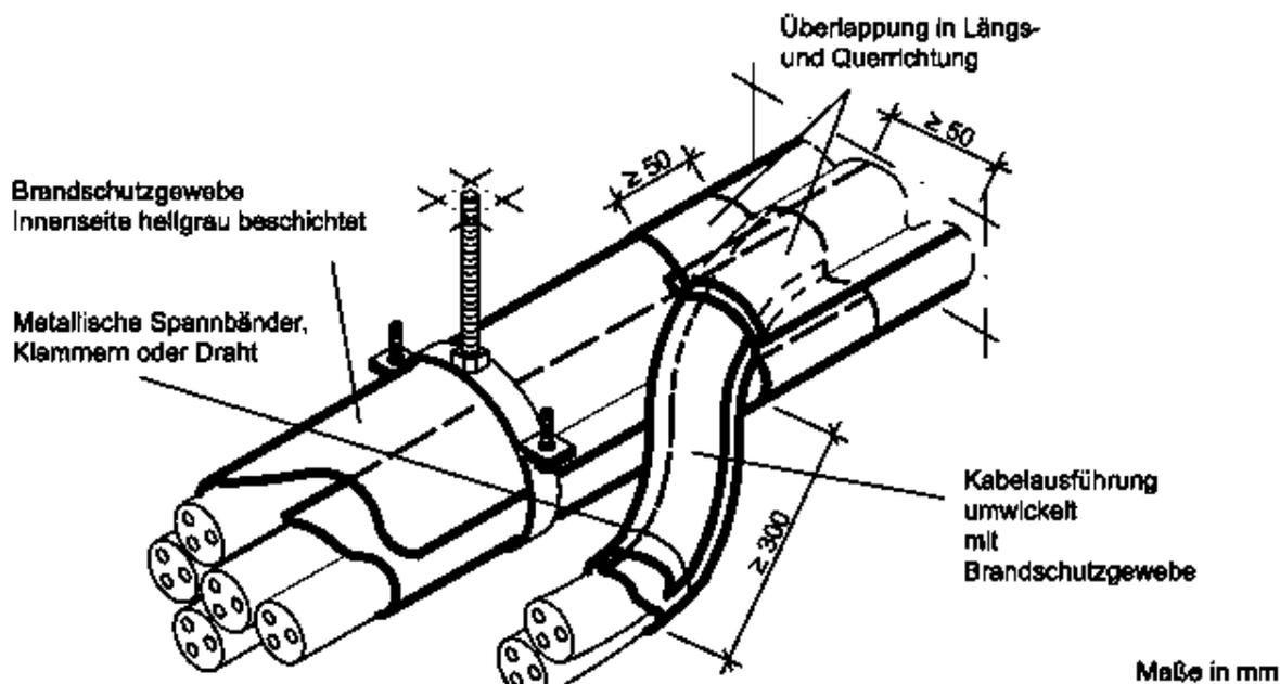
Umhüllungen von elektrischen Leitungen und Leitungsanlagen mit dem
